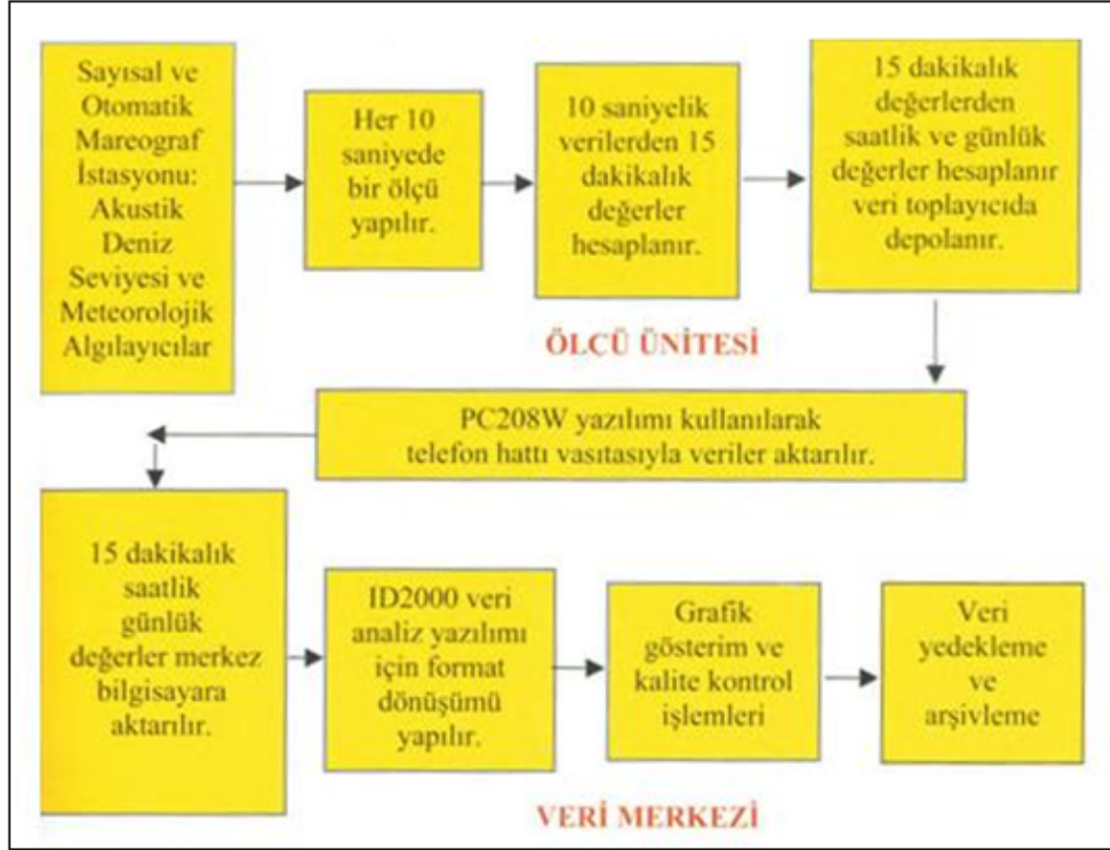
Şekil 1.11. TUDES kapsamında işletilen sayısal-otomatik maregraf istasyonlarındaki veri akışı diyagramı (Yıldız, vd., 2003).
