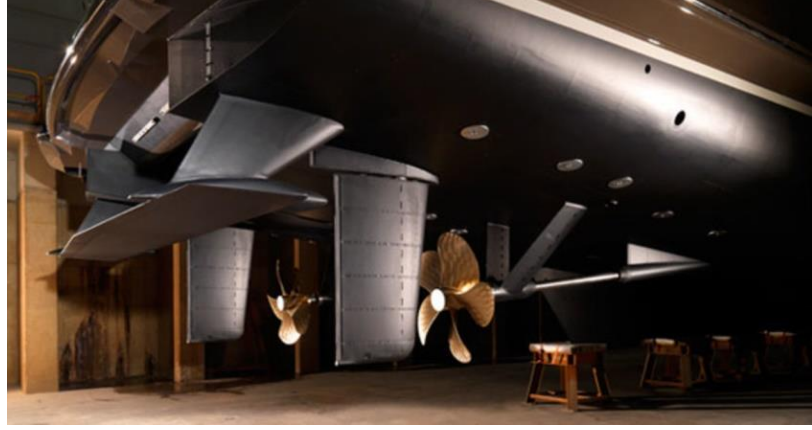
Şekil 1.8. 42 m M/Y Alive gövde kık kanat uygulaması (Uithof vd., 2016).
