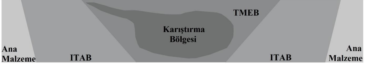
Şekil 7. SKK sırasında malzemede oluşan mikro yapısal bölgelerin şematik gösterimi.
