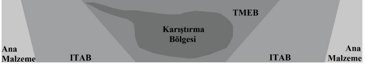
Şekil 5. SKİ sırasında proses edilen malzemede oluşan mikro yapısal bölgelerin şematik gösterimi.
