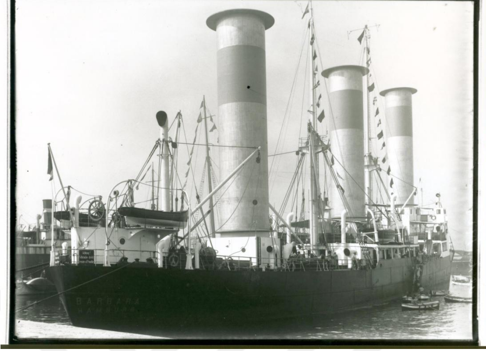
Şekil 1.2. Barselona limanına demirlemiş olan 3 silindirik rotorlu gemi "Barbara"
