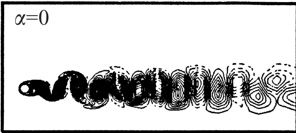
Şekil 1.9. Sabit bir silindirin akış hız çizgilerinin görünümü (Mittal ve Kumar, 2003).
