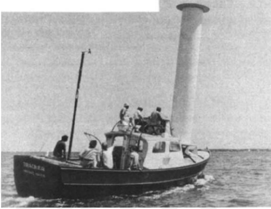
Şekil 1.13. Silindirik rotorun test edilmesi (Bergeson ve Kent Greenwald, 1985).
