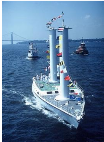
Şekil 1.3. Çift Turbosail'e sahip Alcyone
