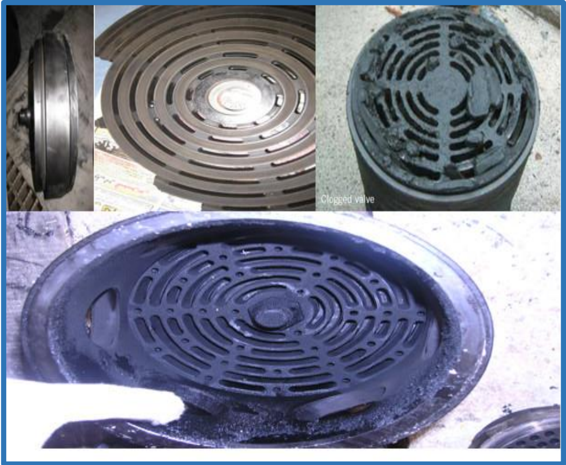
Şekil 44. API 618 kompresörün valfinde olan hasar (Hoerbiger, 2014b; Kobelco, 2006).
