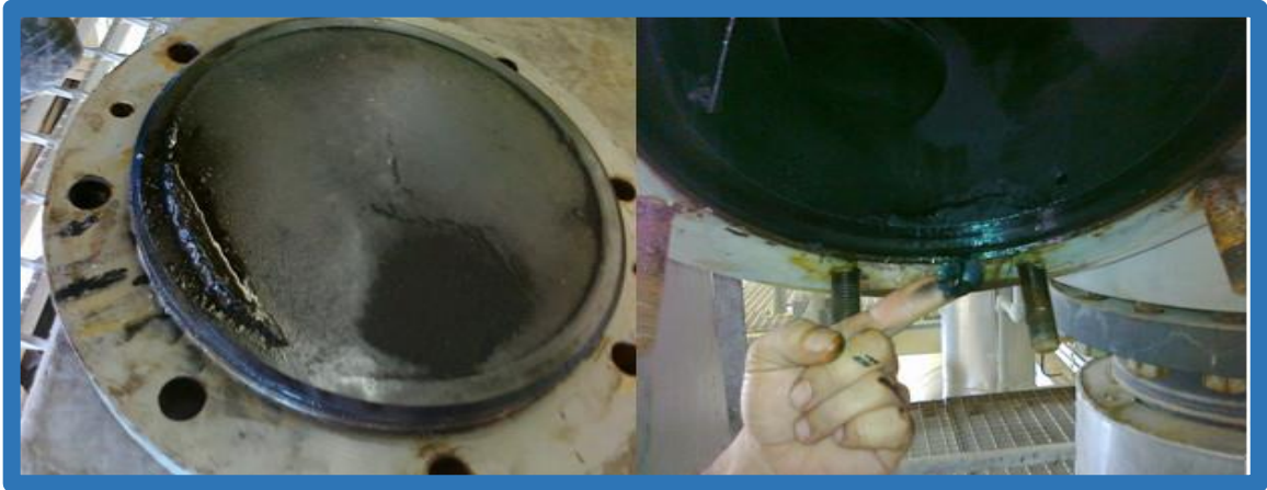
Şekil 49. Kompresör silindirinin aşırı yağlanması ve fazla yağın silindirin içinde birikmesi (Kobelco, 2006).
