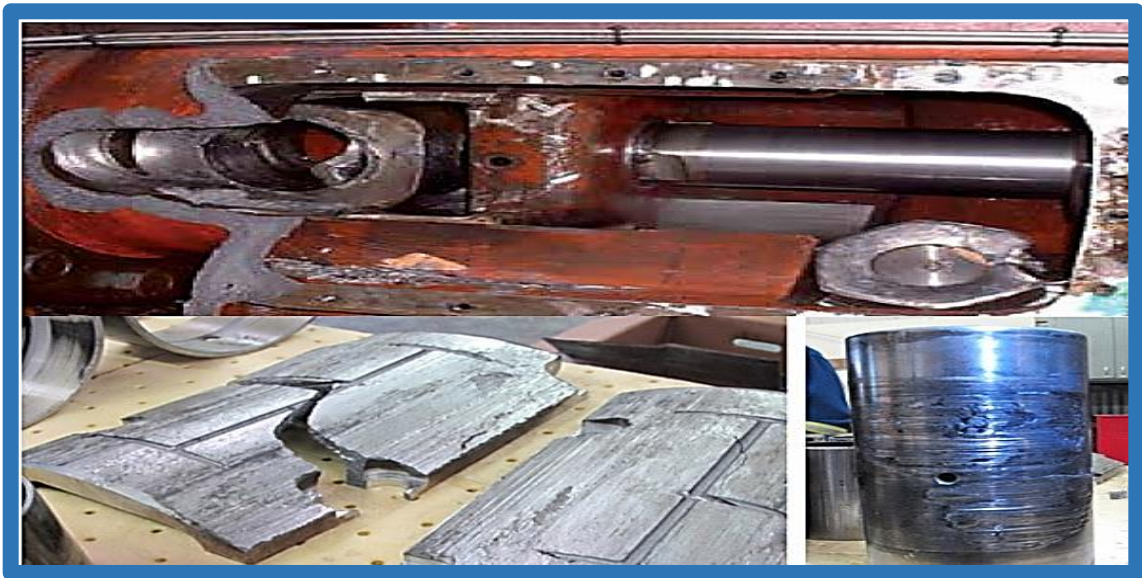
Şekil 46. Kroset donanımının hasarı (Beta machinery, 2015; URL-2,2016).
