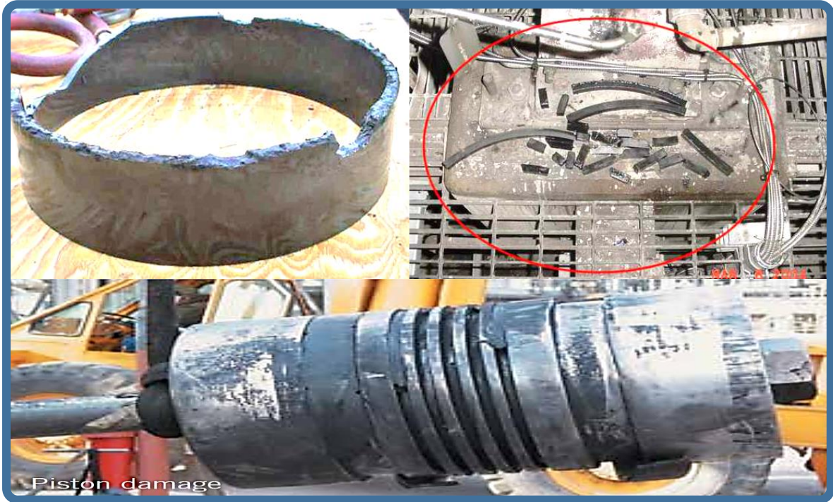
Şekil 43. Hasarlı piston segmanı ve bant tipli segman ile piston ( Hoerbiger, 2014b).
