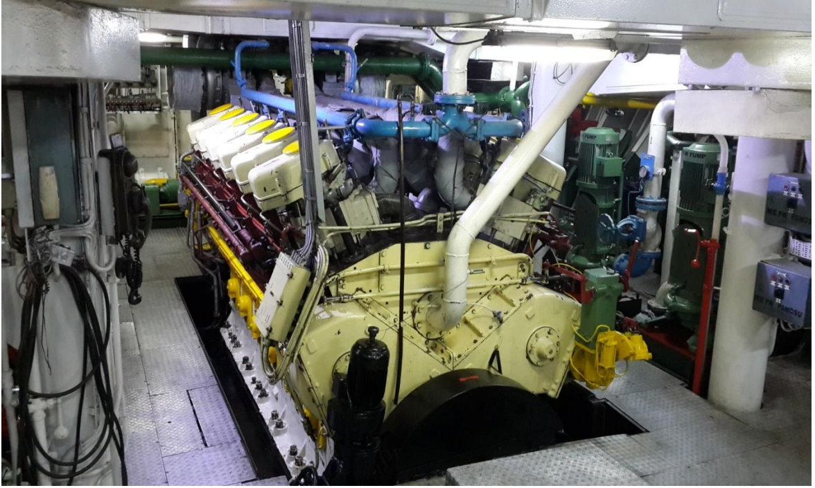
Şekil 1. Dizel motorunun gemi makine dairesindeki yerleşimi
