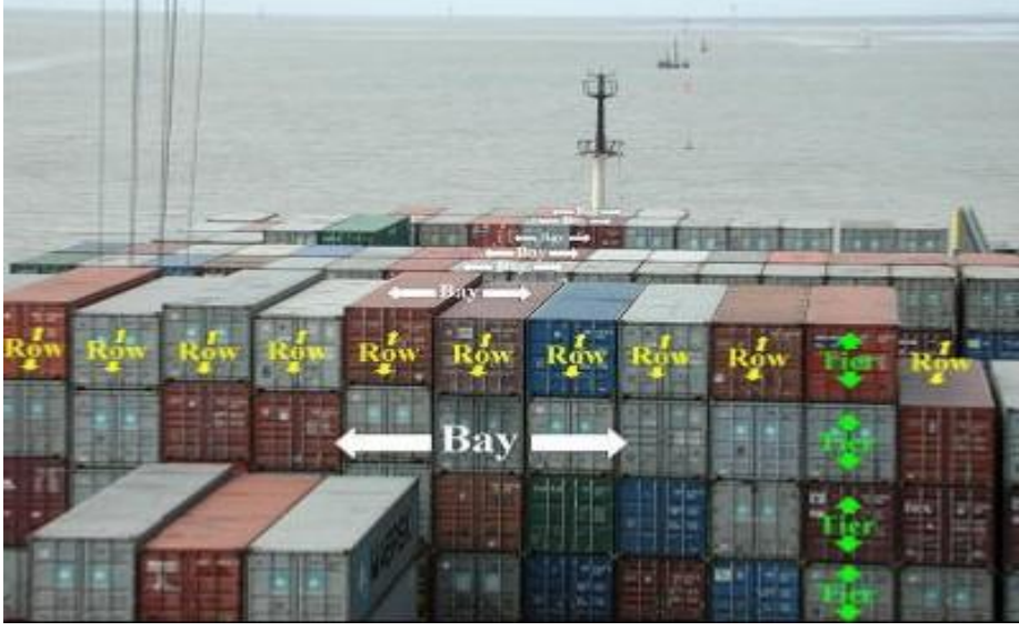
Şekil 1.10. Konteyner gemisinde row-bay-tier terimlerinin gösterimi[URL-4,2014].
