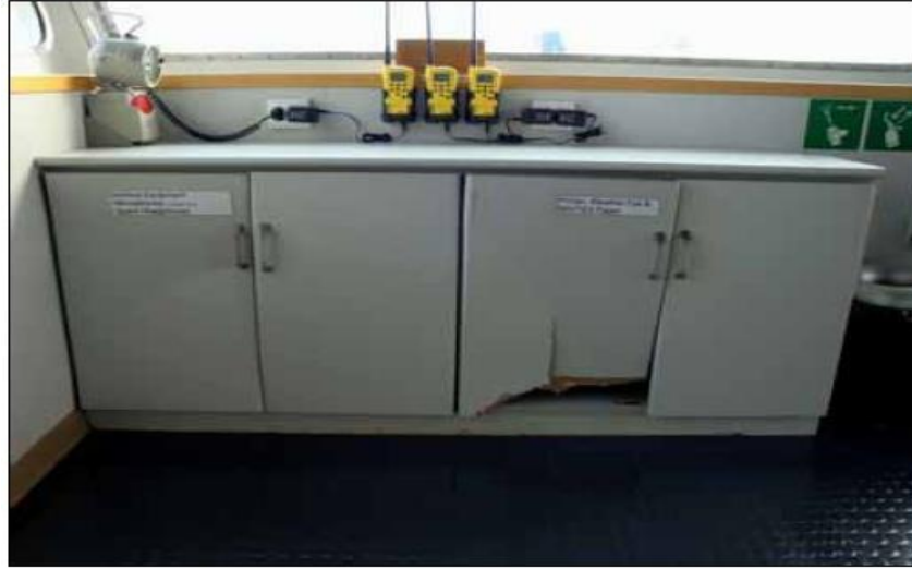
Şekil 3.22. Dolaplardaki mürettebat kaynaklı hasar[22]
