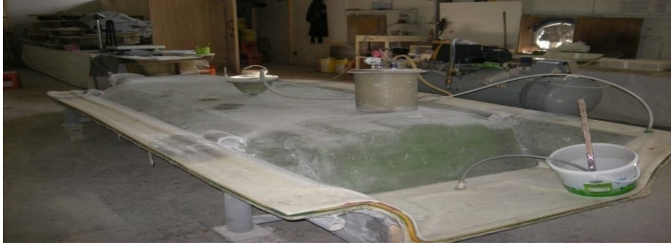
Şekil 8. Üretim aşamasında bir kompozit tekne
