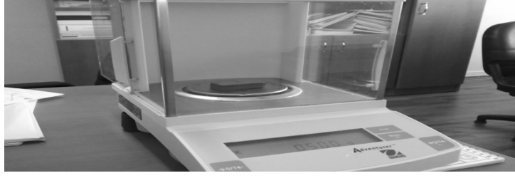
Şekil 25. Polietilen köpük numunenin ağırlığının ölçülmesi
