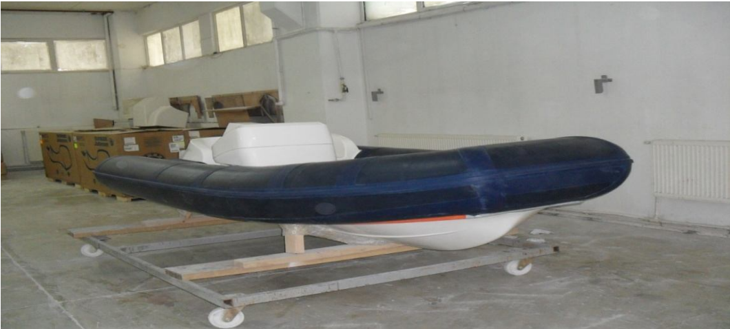
Şekil 24. Üretilen tüp tekneye monte edildikten sonra teknenin görünüşü
