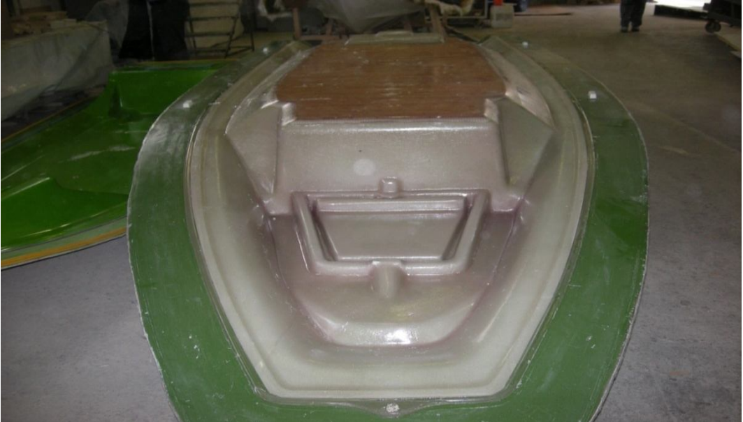
Şekil 19. RTM metoduyla üretilen tekne gövdesi kalıptan çıkarılmadan önce
