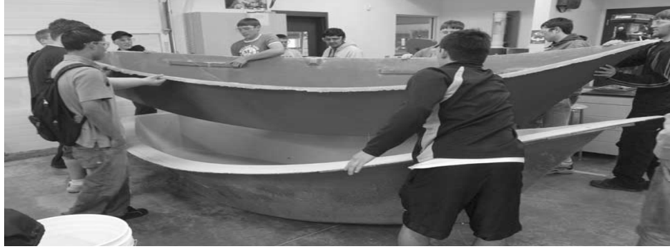
Şekil 15. Üretilen gövdenin kalıptan ayrılması
