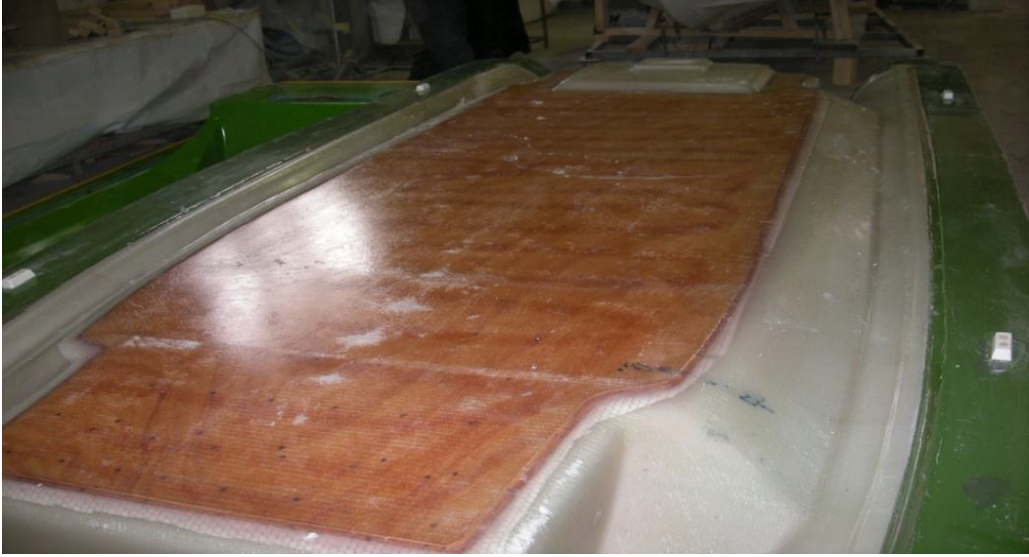
Şekil 17. Tekne gövdesinin üretim aşamasında çekirdek malzeme kullanımı
