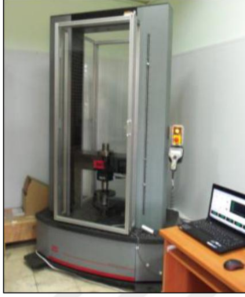
Şekil 6. MTS Criterion 45 serisi universal test sistemi
