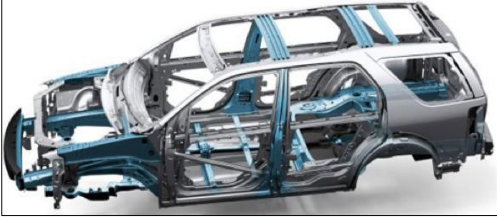
Şekil 1. Araç gövdesinde kullanılan ince cidarlı yapılar (Meriç,2014)
