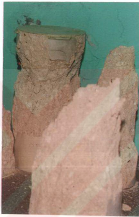
a) hafif betonun kırılması
