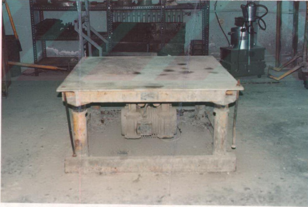
Şekil 13. Betonların yerleştirilmesinde kullanılan sarsma tablası
