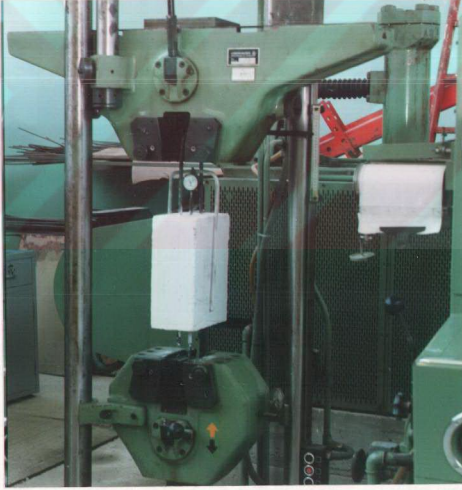
Şekil 35. Eksenel çekip çıkarma deney düzeneği
