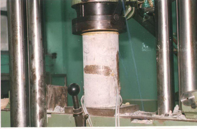
Şekil 14. Betonlar üzerinde gerçekleştirilen merkezi basınç deneyi
