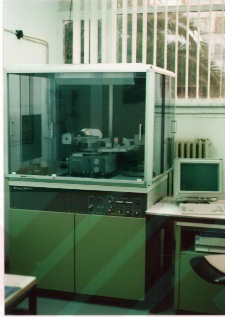
Şekil 24. Rigaku D/Max-IIIc marka x-ışını difraktometresi
