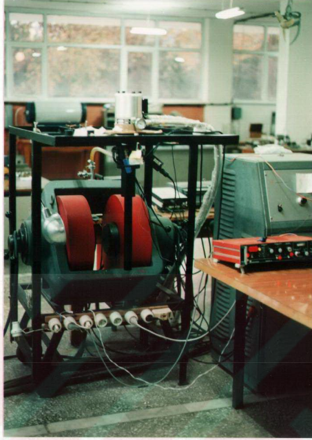
Şekil 26. Leybold-Heraus HR1 model kapalı devre düşük sıcaklık kriyostatu ve Walker MG-2A model elektromıknatıs
