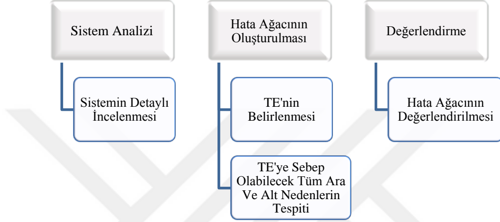
Şekil 8. Hata Ağacı analizinin uygulama şeması (Yavuz, 2018).
