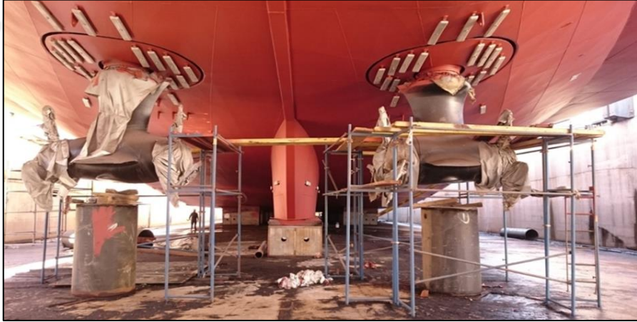
Şekil 8. TCDD-1 feribotunun sevk sistemine ait görüntü
