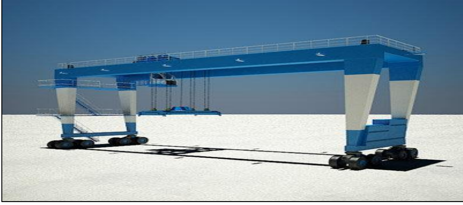
Şekil 3. Lastik tekerlekli köprülü saha vinci (URL-3)
