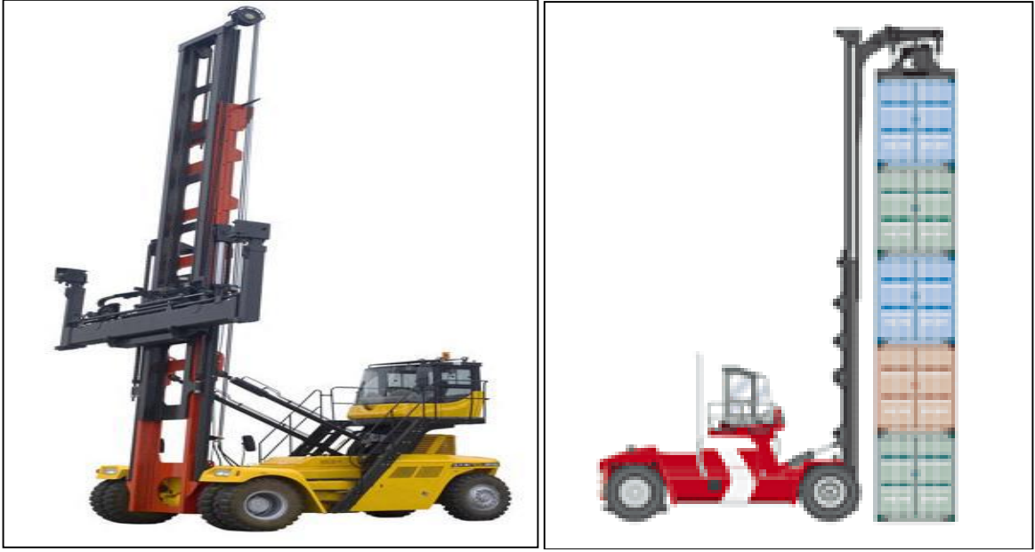
Şekil 8. Boş Konteyner Elleçleme Makinesi (URL-8)
