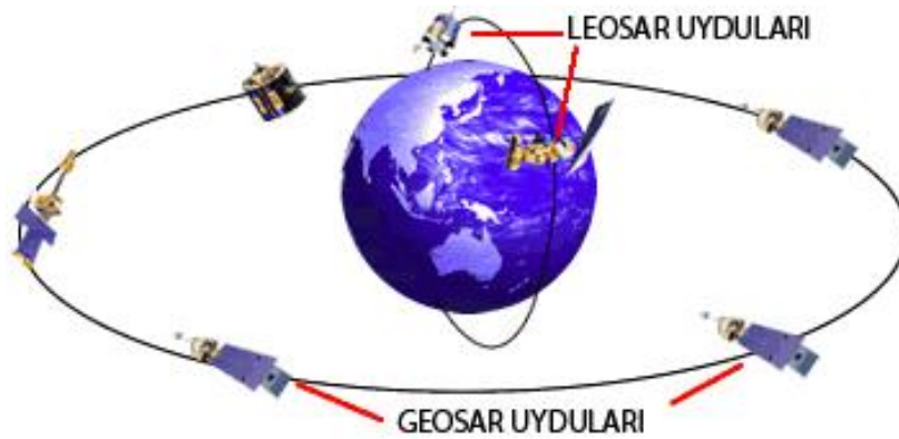
Şekil 4. Leosar ve Geosar uydu yörüngeleri (URL-8, 2010)
