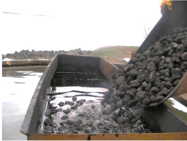
Şekil 18. Yakıcı ecopomex ® ’in bariyer içindeki petrole serbest yüzecek şekilde uygulanması.
