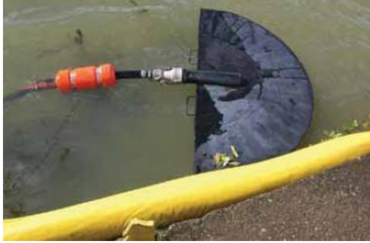
Şekil 10. Vakum pompasına bağlı emici uçlu bir sıyırıcı (ITOPF, 2012)
