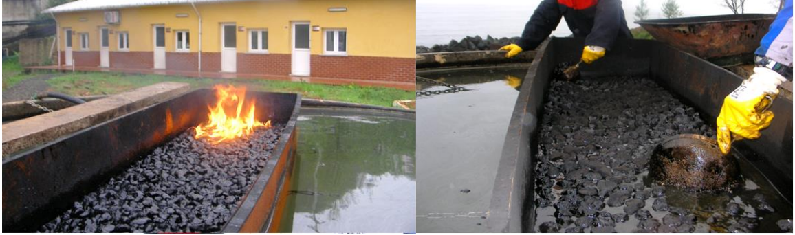
Şekil 19. Serbest halde petrol tabakasına uygulanmış yakıcı ecopomex®'in ateşlemeden birkaç saniye sonraki ve yakım sonrasında toplanmasını gösteren fotoğraf.
