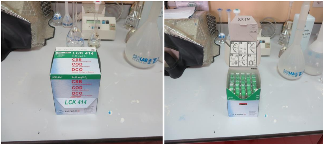
Şekil 2.4. KOİ analizleri için kullanılan küvet testler
