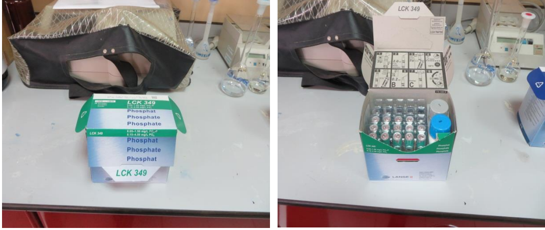
Şekil 2.10. TP analizleri için kullanılan küvet testler
