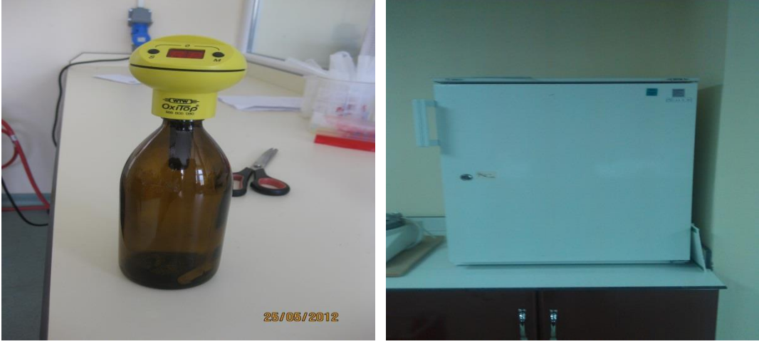
Şekil 2.6. BOİ 5 analizlerinde ölçüm seti ve inkübatör
