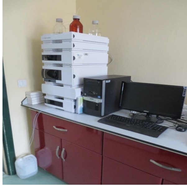
Şekil 2.14. PAH analizleri için kullanılan HPLC cihazı
