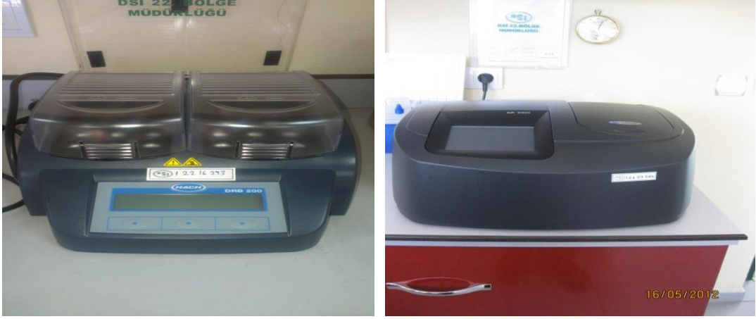
Şekil 2.11. TP analizleri için kullanılan termostat ve spektrofotometre
