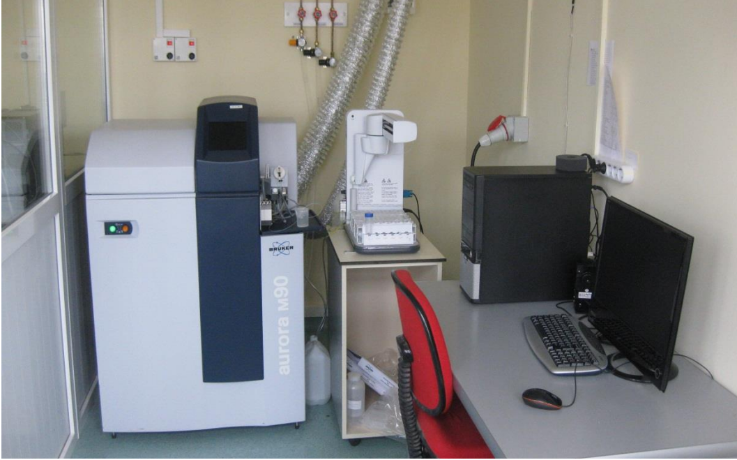
Şekil 2.15. Ağır metal analizleri için kullanılan ICP-MS cihazı
