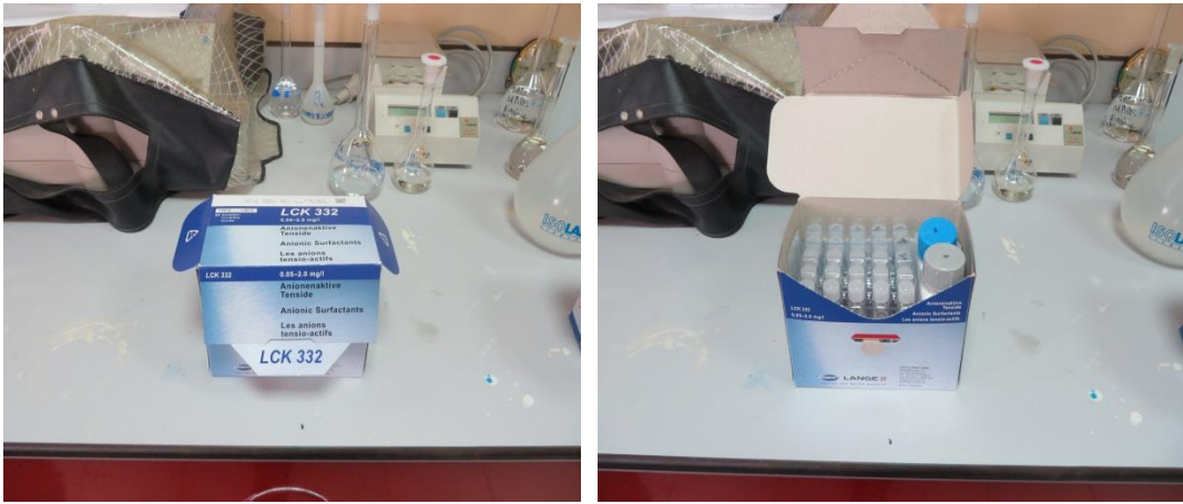
Şekil 2.13. AYAM analizleri için kullanılan küvet testler
