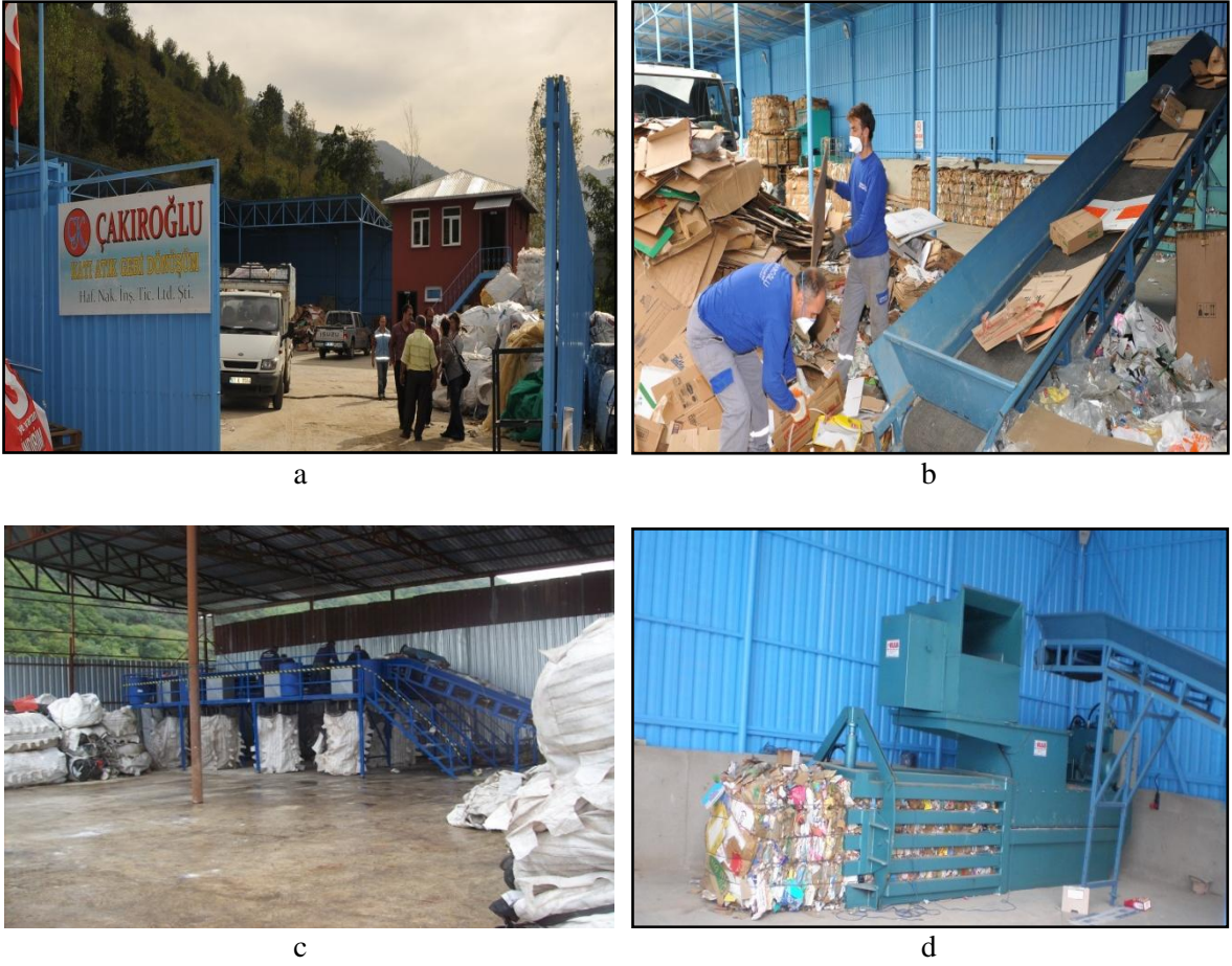
Şekil 2.13. TAT, (a) Tesis genel görünümü, (b) Besleme bandı, (c) Ayırıştırma ünitesi, (d) Pres
