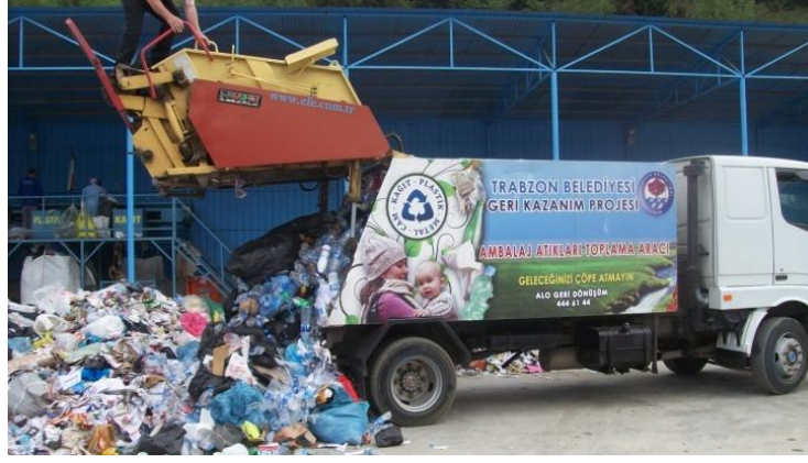
Şekil 2.19. Belediye ambalaj Atığı Toplama Aracı (Sıkıştırılmalı)
