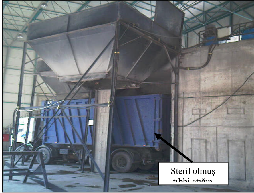
Şekil 28. Sterilizasyon ünitesinden çıkan tıbbi atığın gerekli testler sonuçlanıncaya kadar bekletildiği taşıma aracı
