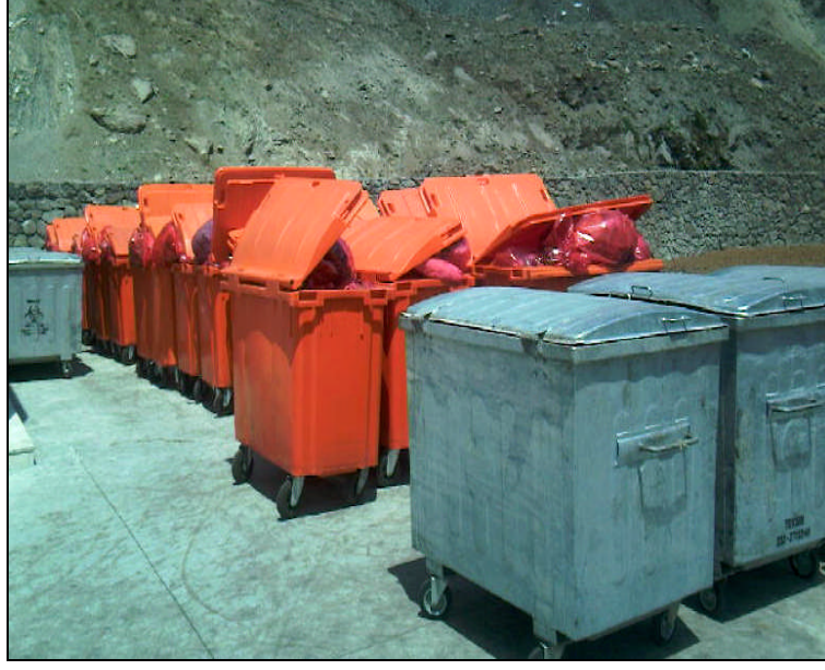
Şekil 20. Tıbbi atıkların sterilizatöre konulması ve boşaltılmasında kullanılan plastik (toplama) ve paslanmaz çelik (boşaltma) konteynırlar (bekleme sahası)
