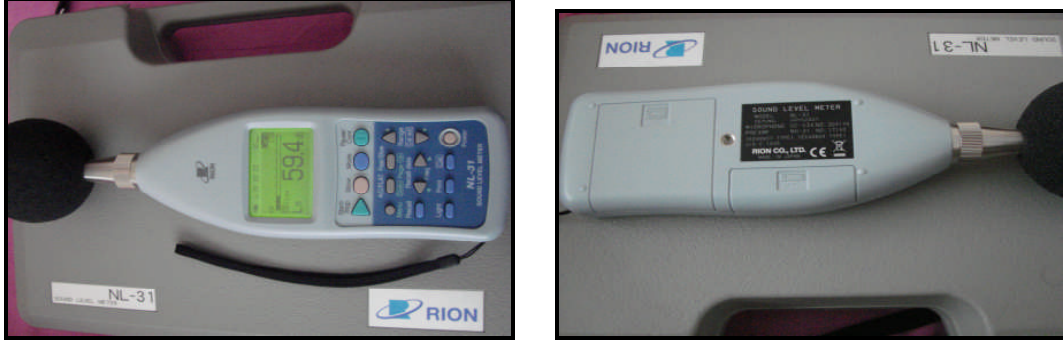
Şekil 17. Gürültü ölçüm cihazının ön ve arka yüzleri
