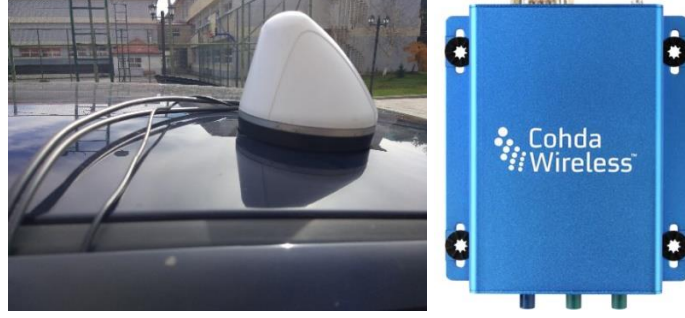
Şekil 9. Araç üzerine yerleştirilen anten ve Cohda Wireless MK5 OBU (DSRC OBU)
