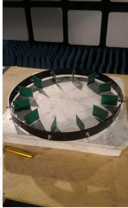
b) 12 adet geniş bantlı Vivaldi anten yerleştirilmiş pleksiglas kasnak
