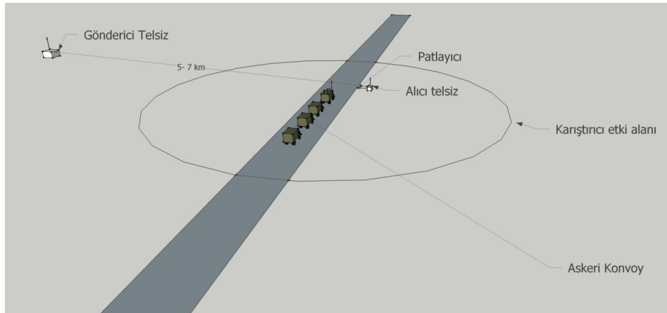
Şekil 3 Konvoy da bulunan karıştırıcı birimin kumandayı etkisiz getirilmesi
