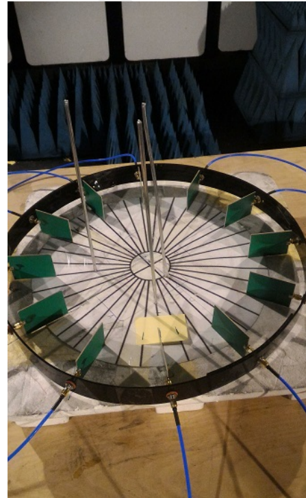
d) Üç tel saçıcı yerleştirilmiş üzenek
