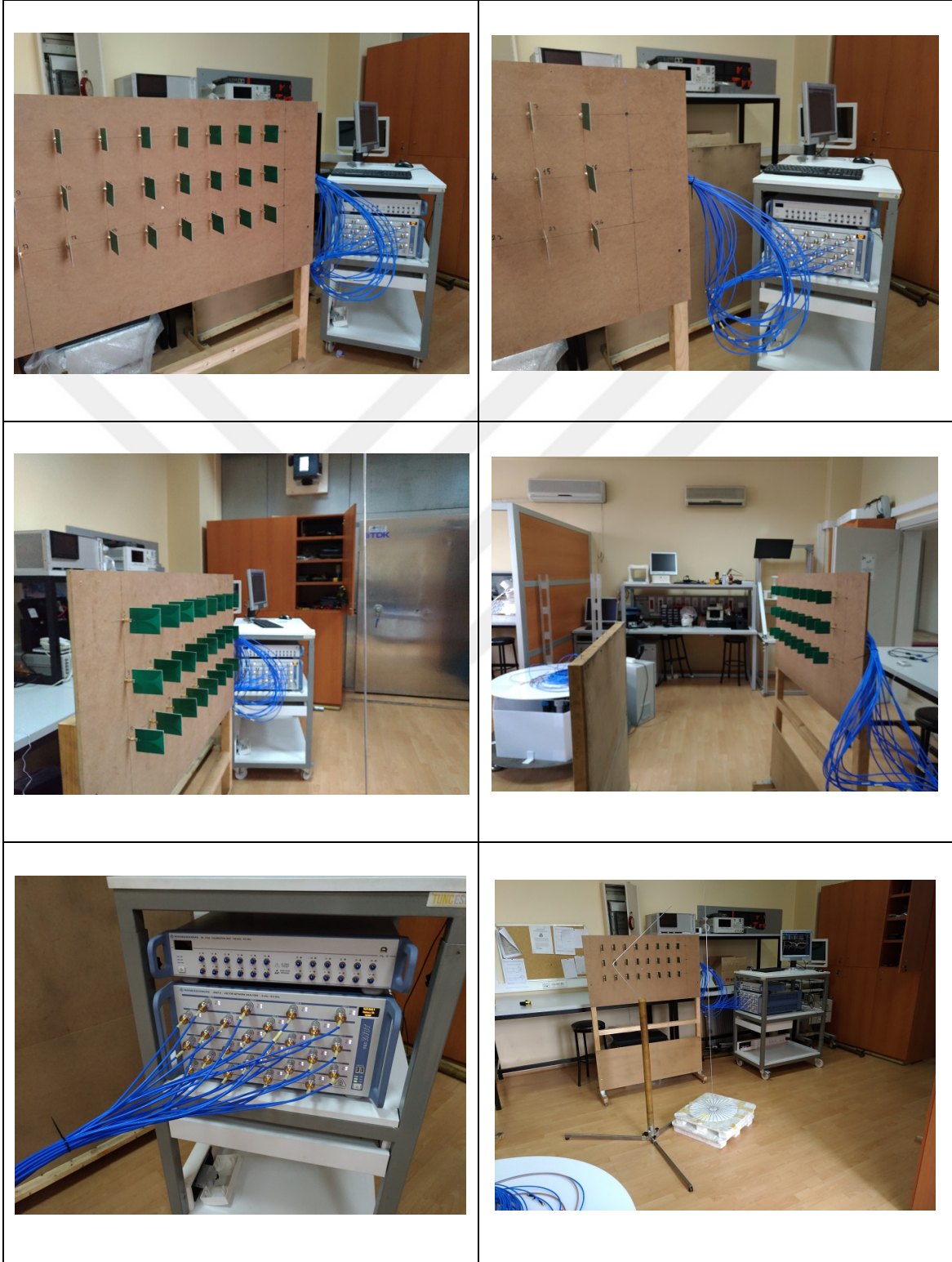
Şekil 61. Kartezyen koordinatlarda tel saçıcı cisimlerin şeklinin belirlenmesi deneylerinde kullanılan anten platformu, ölçme cihazı ve ölçme düzeneği fotoğrafları
