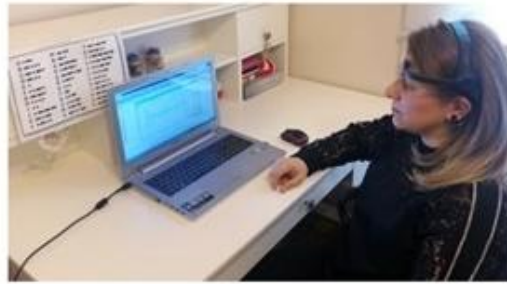
Şekil 28. (a) Elektrot pozisyonlarının harflendirilmesi (b) Kablosuz Neurosky MindWave cihazı (c) Kablosuz Neurosky MindWave cihazının kafaya yerleştirilmesi ve kayıt oturumu
