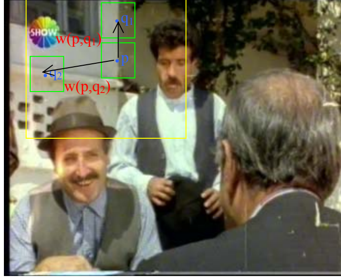
Şekil 2.2. Yerel olmayan-ortalamalar yöntemi. Benzer komşuluk bölgesi piksellerden w(\mathbf{p}, \mathbf{q}_1) gibi büyük değerli ağırlıklar elde edilirken, çok daha farklı komşuluk bölgelerinden w(\mathbf{p}, \mathbf{q}_2) gibi küçük değerli ağırlıklar elde edilecektir. Yeşil renkle işaretli bölge piksel komşuluk bölgeleri ve sarı renkle işaretli bölge ise kaynak (arama) bölgesidir
