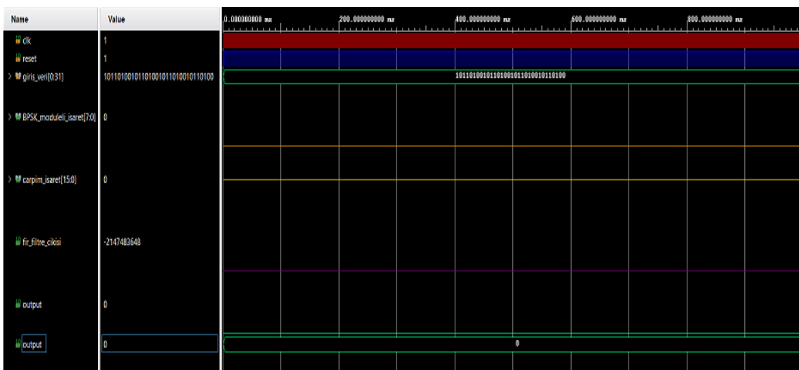
Şekil 40. rising_edge_clk = '1' , trailing_edge_clk = '0' ve reset = '1' olduğunda, giriş_veri:= [10110100101101001011010010110100] için benzetim sonucu
