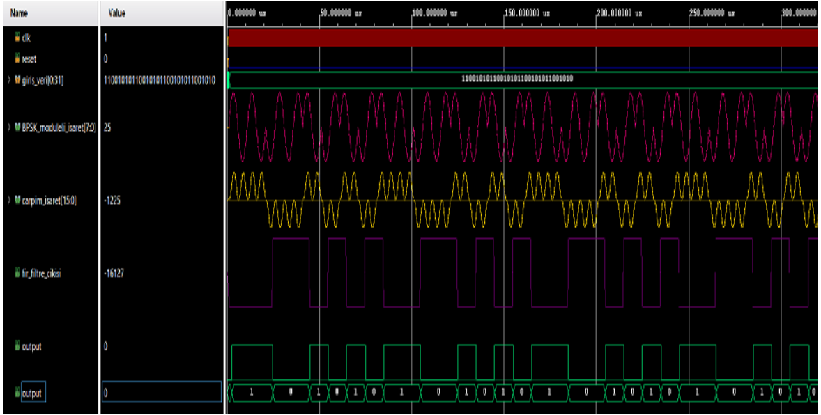
Şekil 42. rising_edge_clk = '1' , trailing_edge_clk = '0' ve reset = '0' olduğunda, giriş_veri:= [11001010110010101100101011001010] için benzetim sonucu
