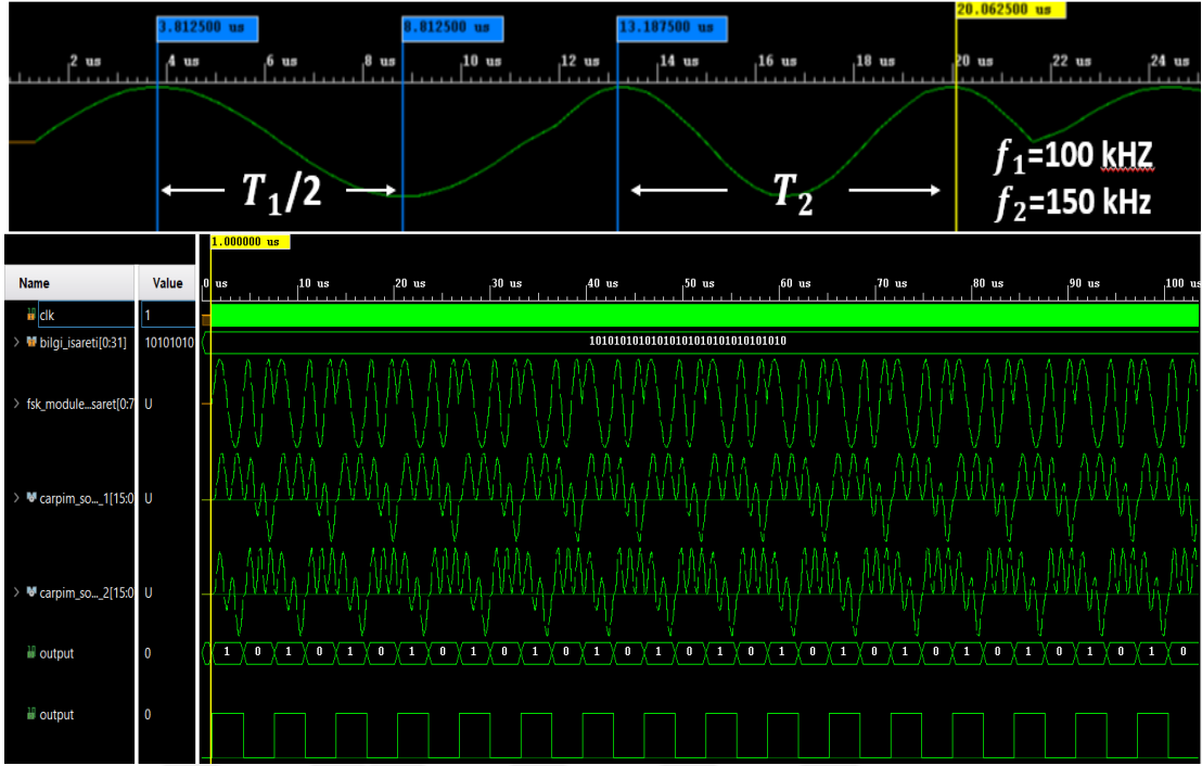
Şekil 2.17. Taşıyıcı işaret frekansları 100 ve 150 kHz olduğu durum
