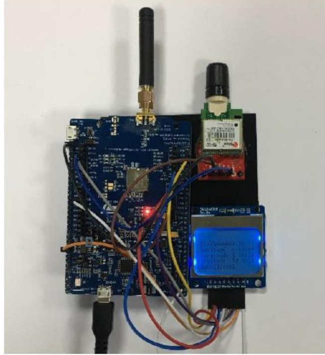
Şekil 2.3. Bir ekrana ve GPS modülüne bağlı B-L072Z-LRWAN1 kiti
