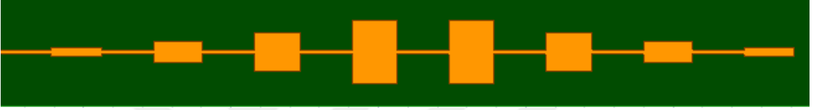
Şekil 16. Binomial dağılımı kullanarak mikroşerit yama antenin 1x8 konik dizisi
