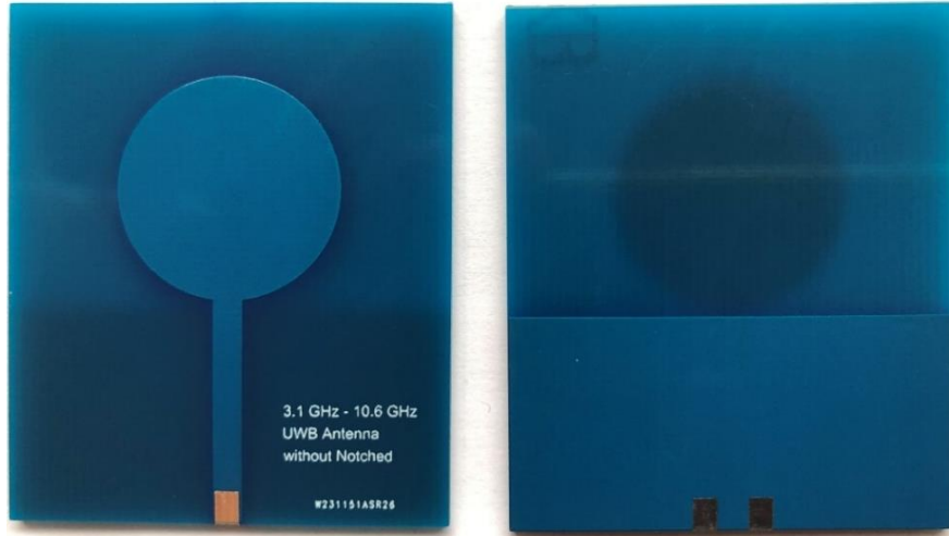
Şekil 13. Üretilen Birincil Anten ön ve arka fotoğrafı
