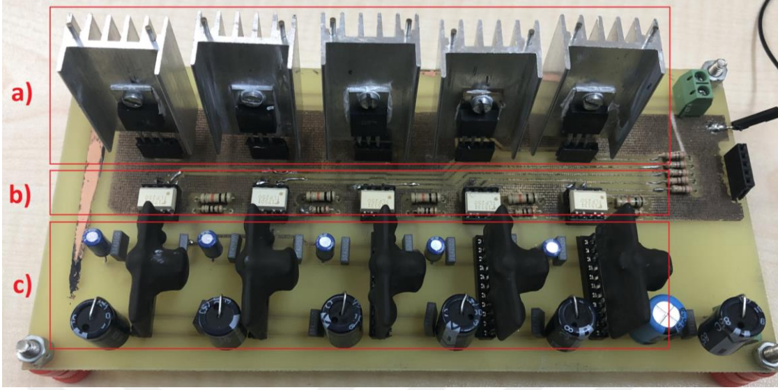
Şekil 60. Tasarlanan H5 evirici ve sürücü kartının görünümü (a: Evirici anahtarlama elemanları, b: İzoleli optik sürücü katı, c: Sürücü besleme katı)
