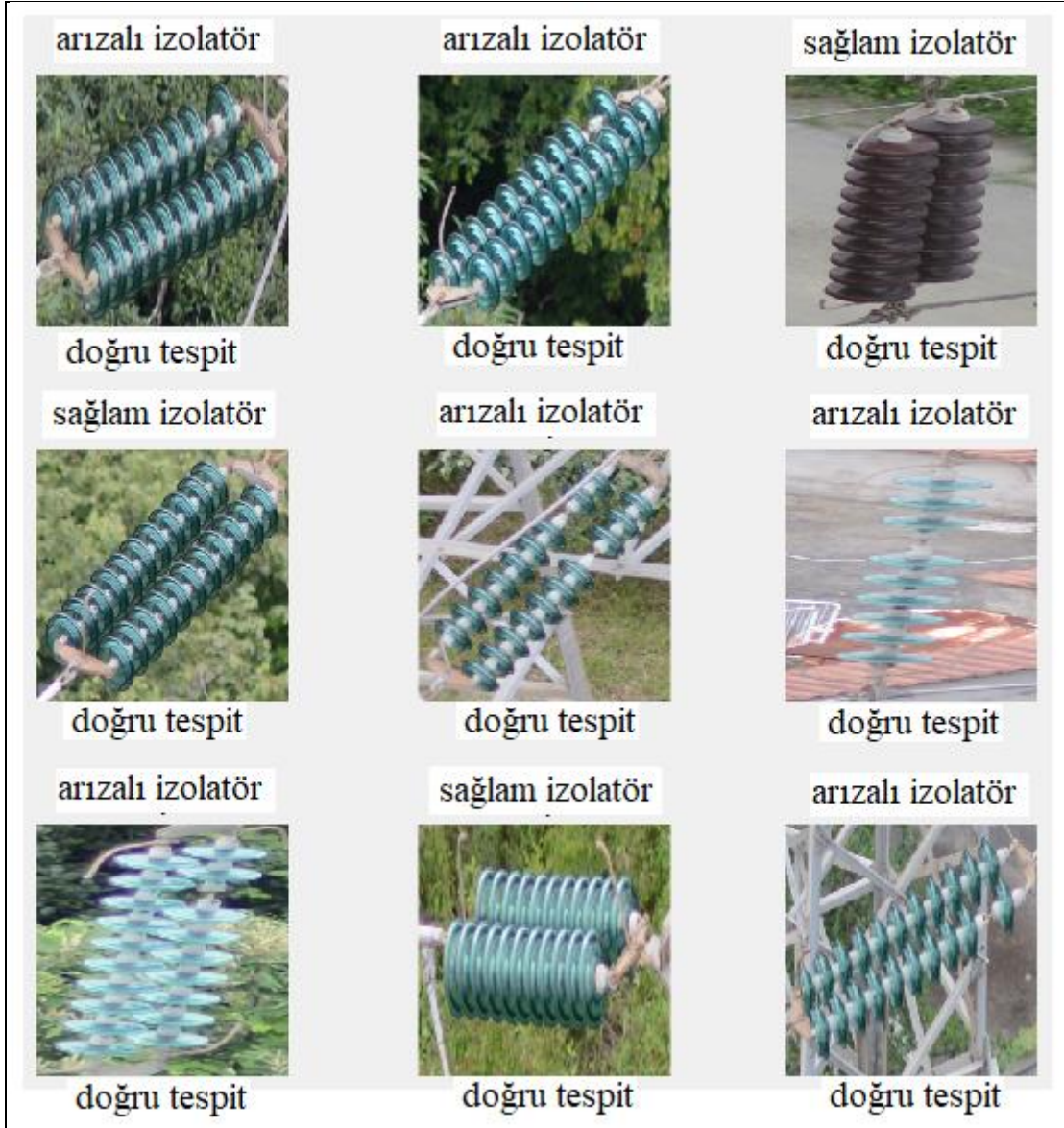
Şekil 2.63. Yüzdelik doğruluk başarım sonucunun %72,12 olduğu durumda, rastgele seçilen 9 adet izolatörün bilgisayar tarafından hangi sınıfa ait olduğunun tespitinin gösterimi
