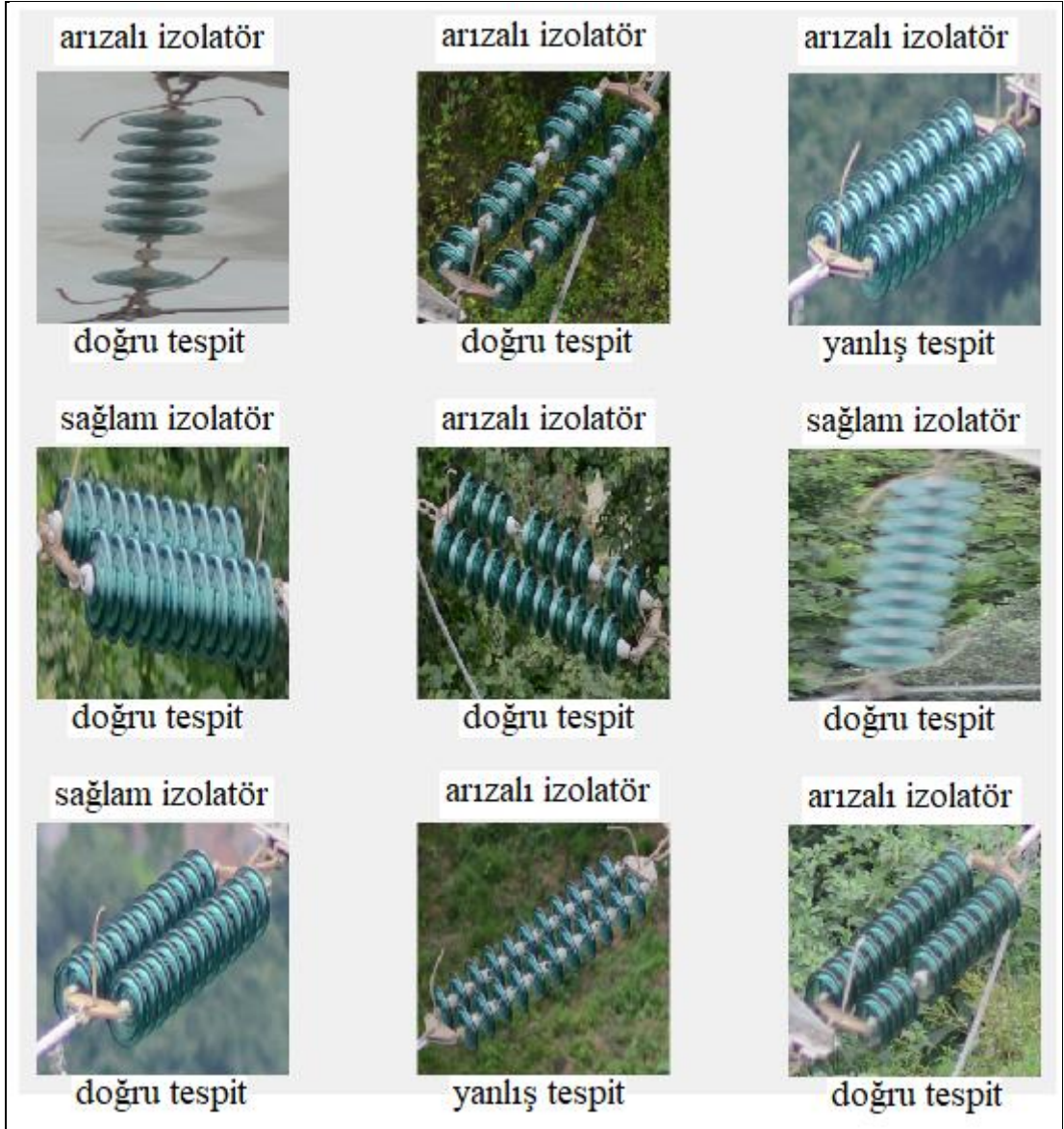
Şekil 2.64. Yüzelik doğruluk başarımlarının %66,35 olduğu durumda, rastgele seçilen 9 adet izolatörün bilgisayar tarafından hangi sınıfa ait olduğunun tespitinin gösterimi
