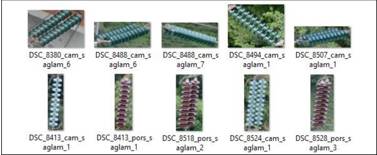
Şekil 2.60. Kesme işlemi sonucu oluşan sağlam izolatörlerden bazıları
