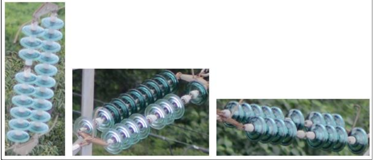
Şekil 2.2. Birinci sınıfımız olan "arizali_cam" etiketini kullandığımız arızalı cam izolatörlerden bazıları
