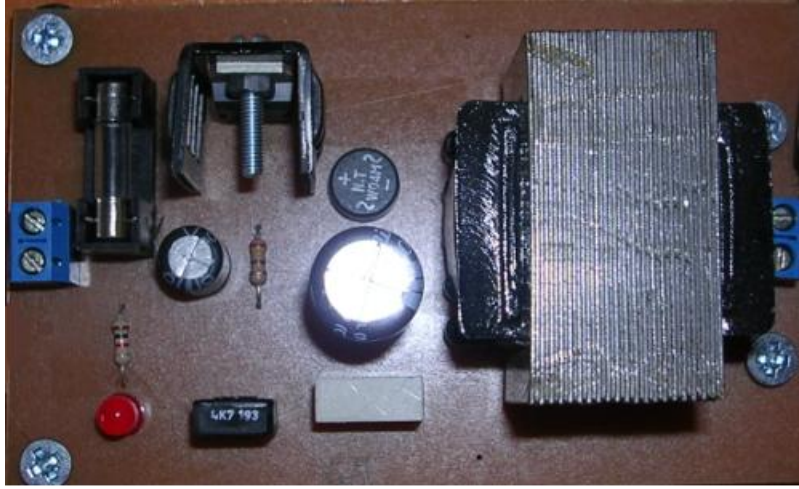
Şekil 2.4. Anahtarlama devresini besleyen güç kaynağı
