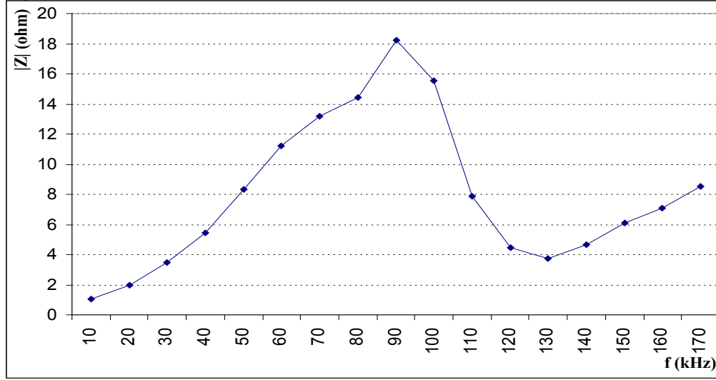
Şekil 68. Sanayi ortamında empedansın frekansa bağlı olarak ortalama değişimi
