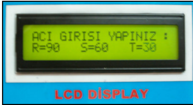
Şekil 2.11. Anahtarlama açılarının girişinin görselleştirildiği LCD
