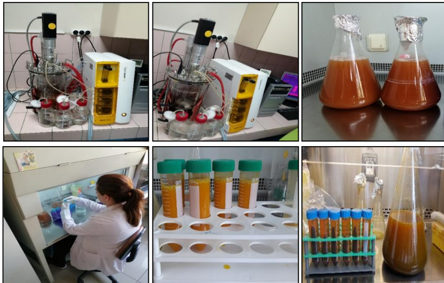
Şekil 11. KTU-24'ün fermentörde üretilmesi ve saflaştırılması
