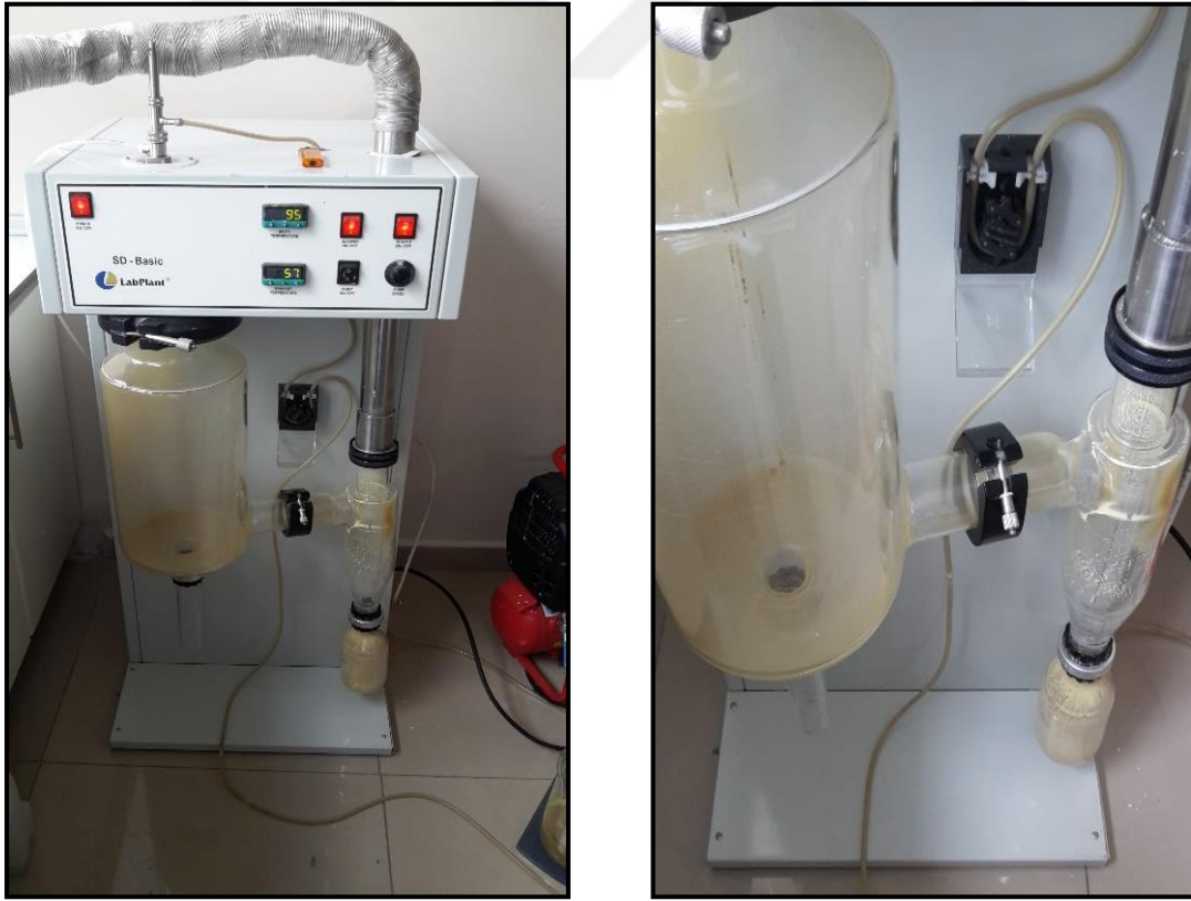
Şekil 12. Fermentörde üretilen KTU-24'ün blastosporlarının sprej kurutucuda kurutma
