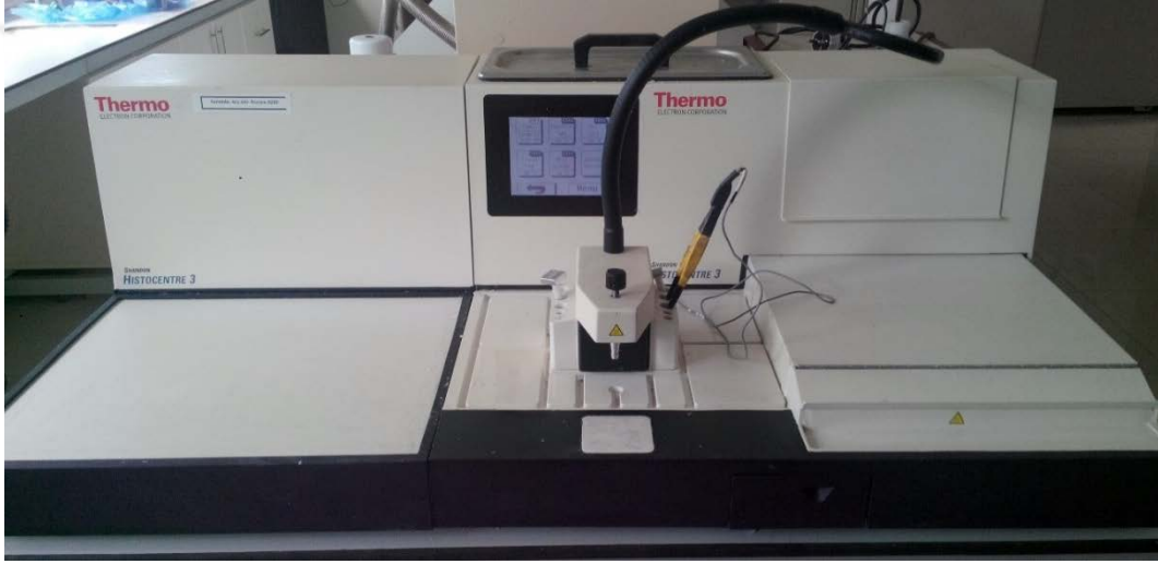
Şekil 10. Parmak örneklerinin parafin bloklara gömüldüğü parafin bloklama cihazı
