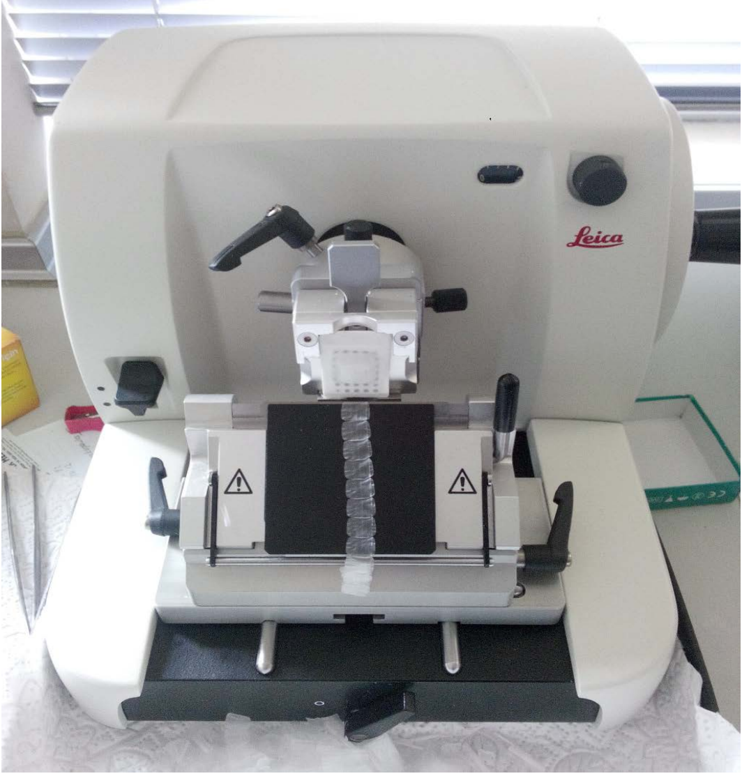
Şekil 13. Leica marka döner kollu mikrotomla kesitlerin alınması
