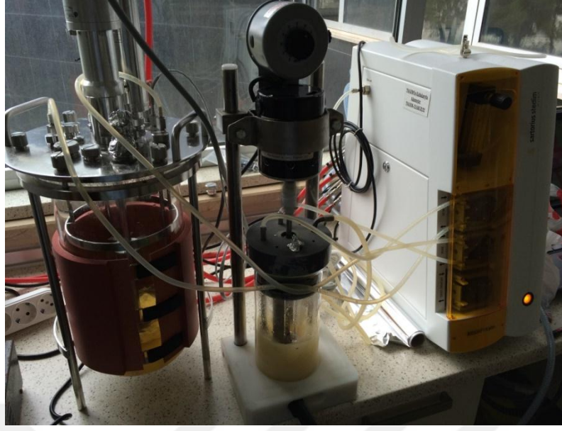
Şekil 18. Mikrobaloncuk üreten cihazın FAE üretiminde fermentörle birlikte kullanımı
