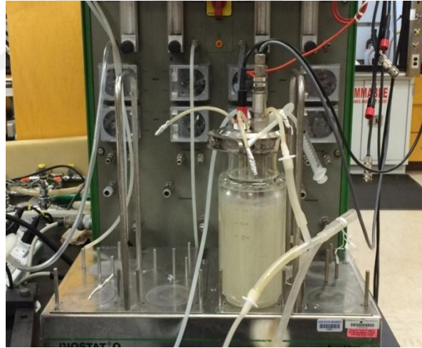
Şekil 14. PHB üretiminde kullanılan fermentör
