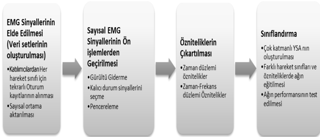
Şekil 26. Yapılan çalışmaların temel işlem adımları
