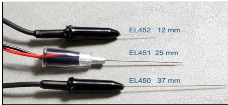
Şekil 4. EMG sinyalleri elde etmede kullanılan iğne elektrotları [17].
