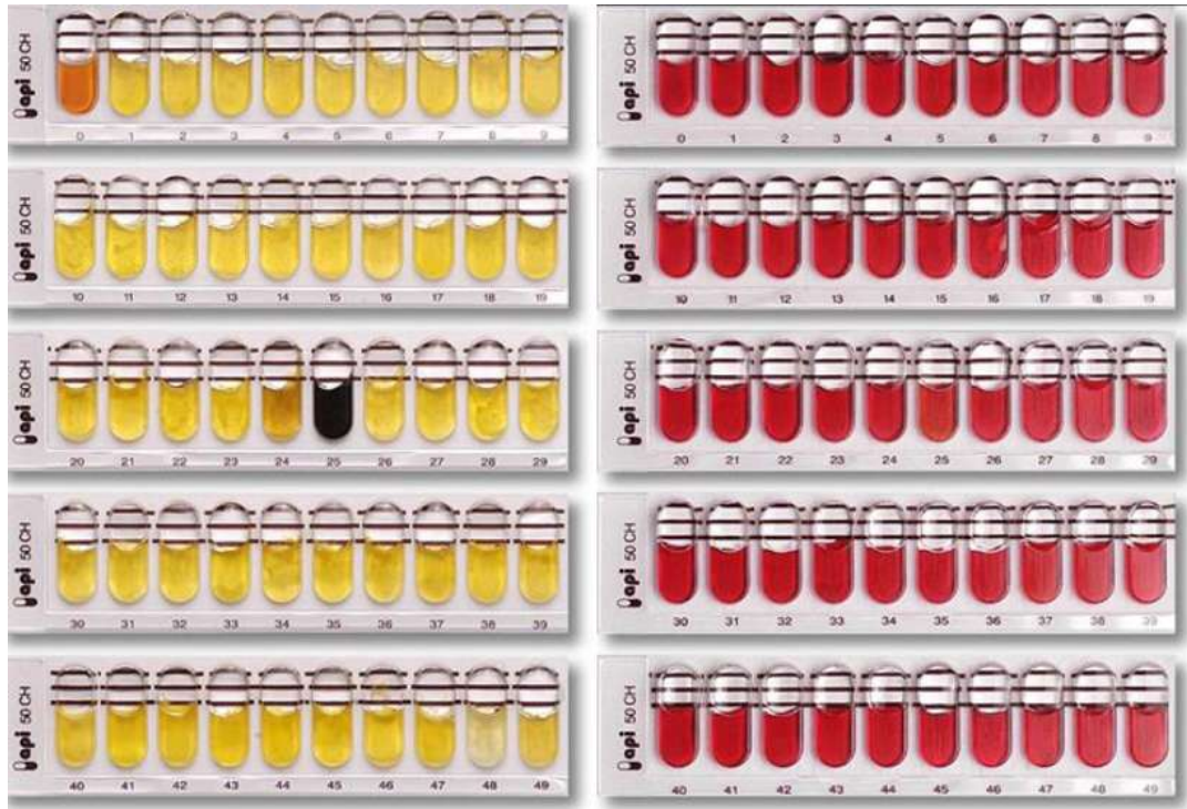
Şekil 18. Bakteriyal izolatların API 50CHB test sistemi sonuçları. Pozitif (solda) ve negatif (sağda) görüntüler
