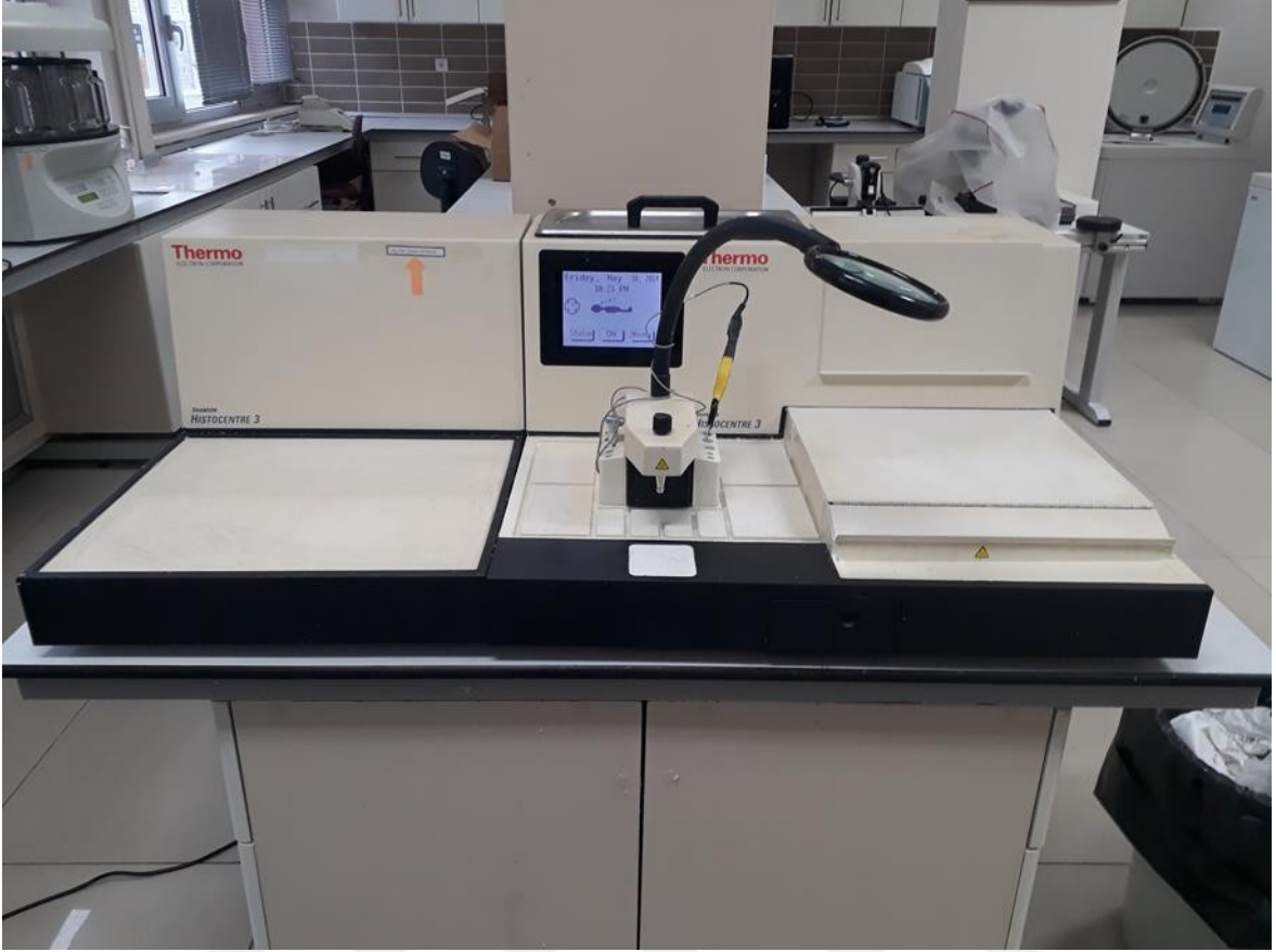
Şekil 17. Rana dalmatina bireylerine ait kemik doku örneklerinin parafin bloklara gömüldüğü parafin bloklama cihazı (Foto: Mustafa ALBAYRAK)
