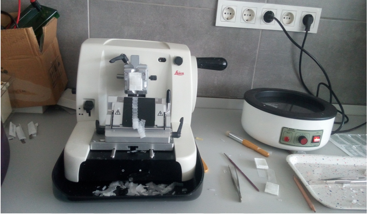
Şekil 19. Kesit alma işlemi esnasında kullanılan Döner Kollu Mikrotom (Foto: Mustafa ALBAYRAK)
