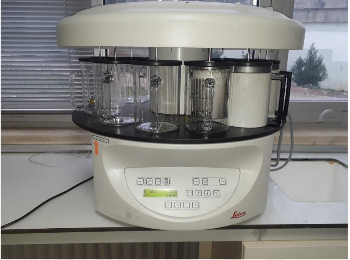
Şekil 16. Rana dalmatina bireylerine ait kemik dokusu örneklerine doku takibi işlemini uygulayan cihaz (Foto: Mustafa ALBAYRAK).
