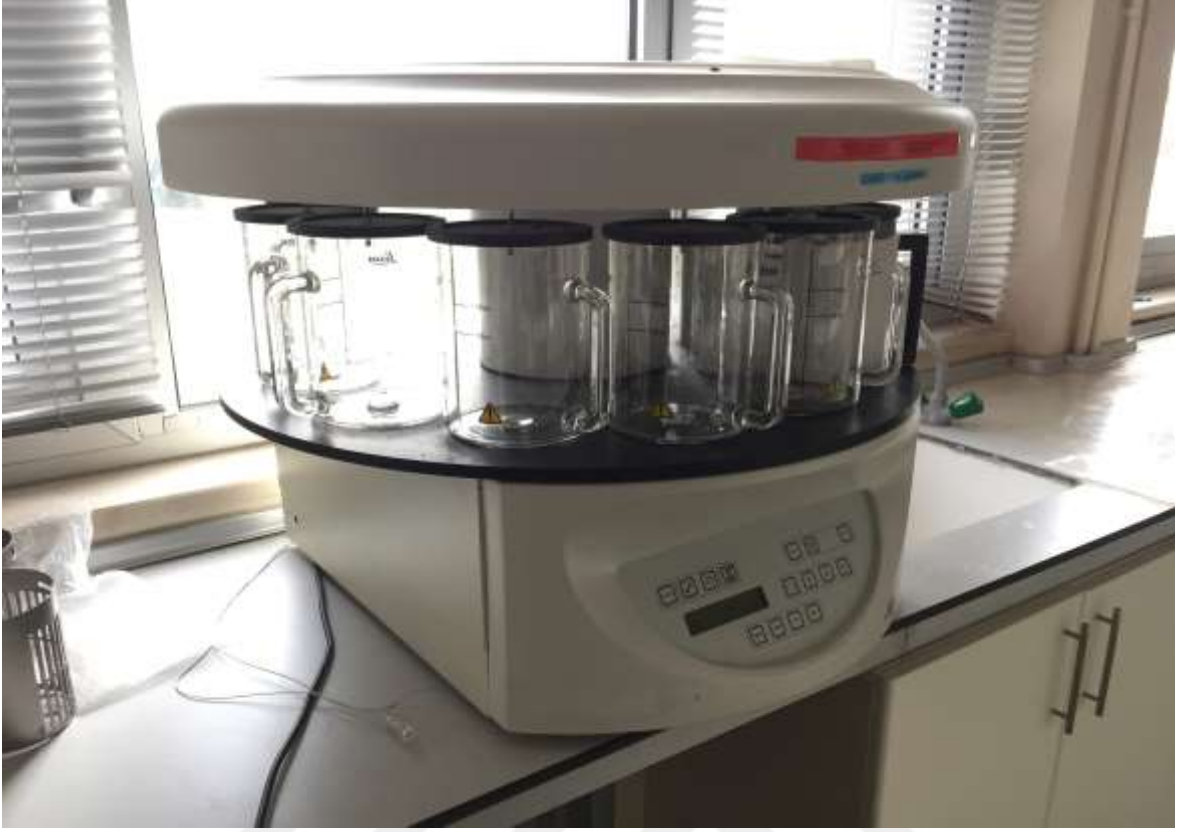
Şekil 5. Lacerta media bireylerinin kemik doku örneklerinin doku takibi işlemlerinin yapıldığı doku takip cihazı (Foto: Mustafa Okan Bayrak)
