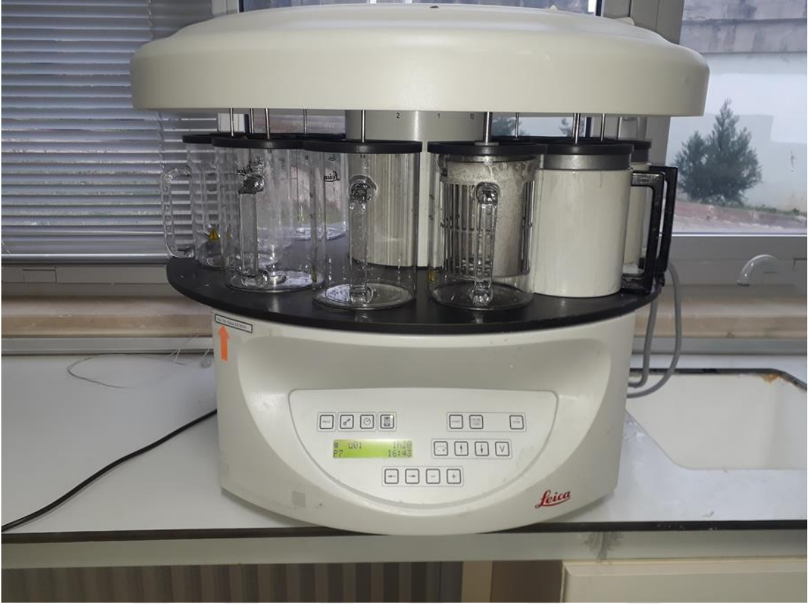
Şekil 5. Mediodactylus kotschyi bireylerine ait kemik dokusu örneklerinin doku takip işlemini gerçekleştiren cihaz (Foto: Hatice ÖZKAN)
