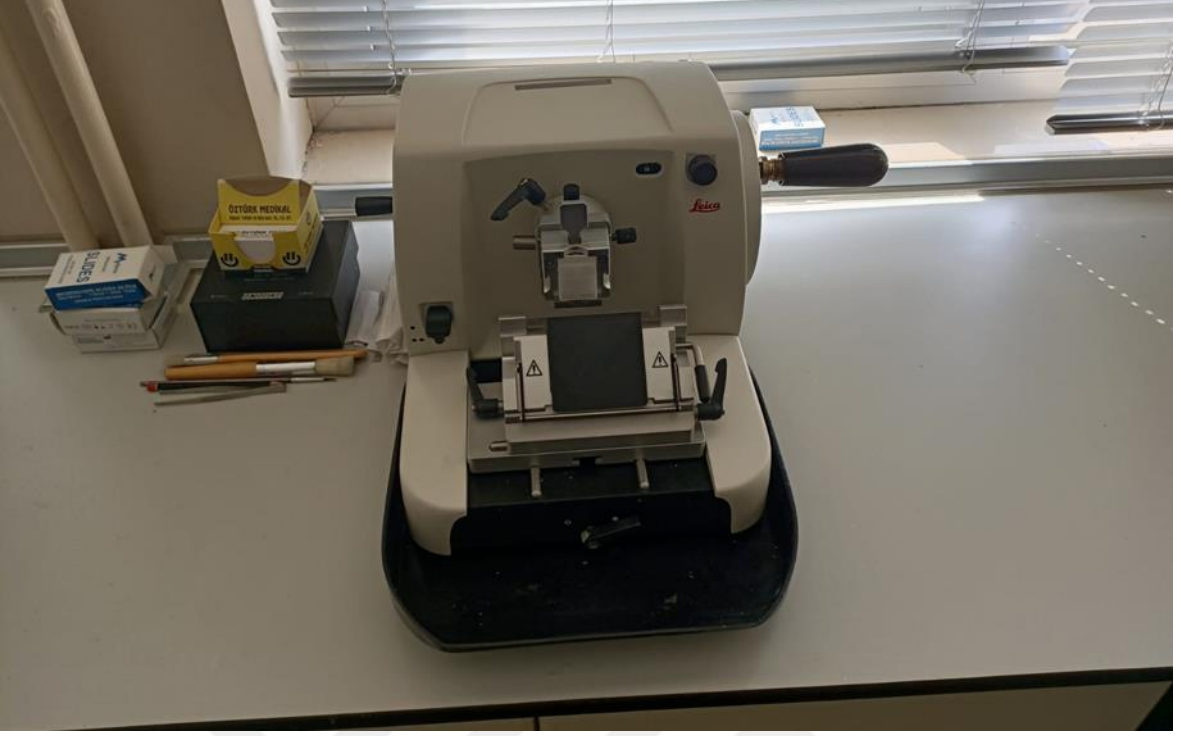
Şekil 8. Kesit alma işlemi için kullanılan Döner Kollu Mikrotom (Foto: Mustafa ALBAYRAK)
