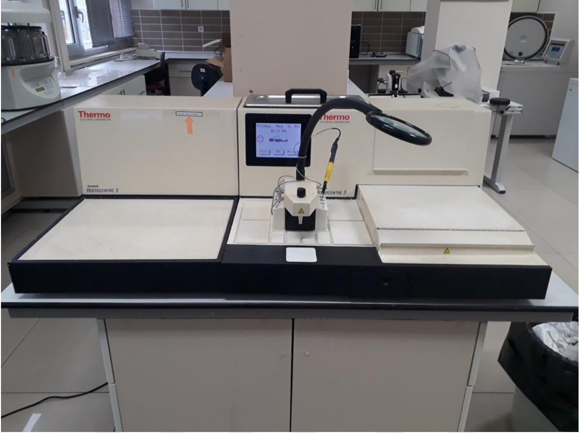
Şekil 6. Mediodactylus kotschy bireylerine ait kemik doku örneklerinin parafin bloklara gömüldüğü parafin bloklama cihazı (Foto: Hatice ÖZKAN)
