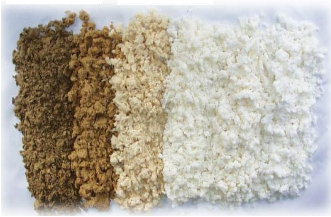
Şekil 2. Kraft hamurunun kademeli olarak ağartılması sonucunda renk değişimi
