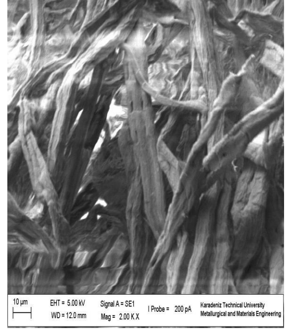
Şekil 9. Okaliptus kraft kağıt hamuru liflerinin SEM görüntüsü (A. Geo7 1 Endoksilanaz Enzimi muamelesi B. Kontrol)
