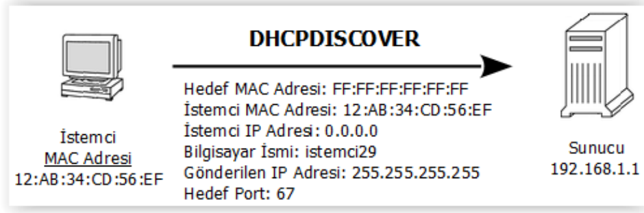
Şekil 1.6. DHCP istemcisinin gönderdiği DHCPDISCOVER mesajı
