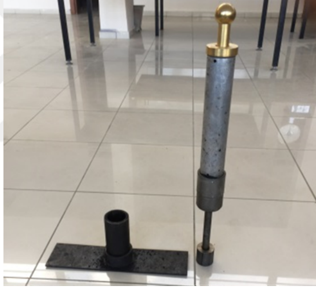
Şekil 2.4. Dinamik üç eksenli deney numunelerinin hazırlanmasında kullanılan çelik kalıp ve sıkıştırma elemanı
