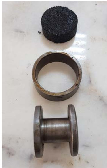
Şekil 2.6. Çevrimsel basit kesme numunesi ve kalıbı
