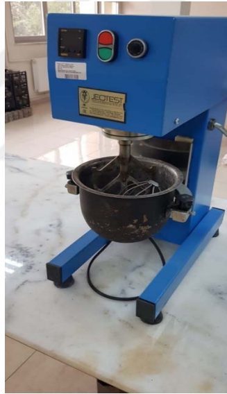
Şekil 2.3. Karışımları hazırlamak için kullanılan bitüm mikseri
