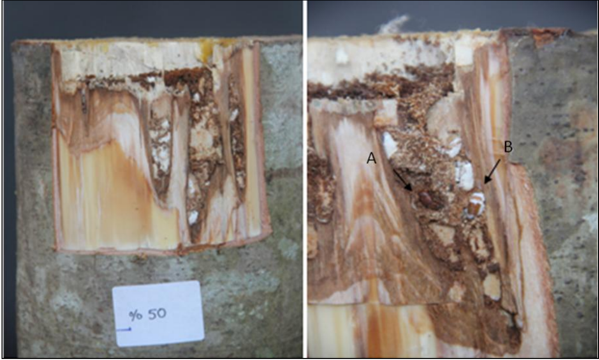
Şekil 31. Larvaların % 50'si enfekte edilerek gerçekleştirilen kütük denemeleri; A: Enfekte olmamış D. micans ergini; B: Enfekte olmuş D. micans ergini
