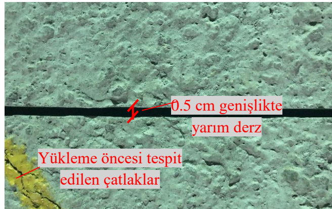
Şekil 2.9. Genişliği 0.5 cm olan kesilip temizlenmiş yarım derz
