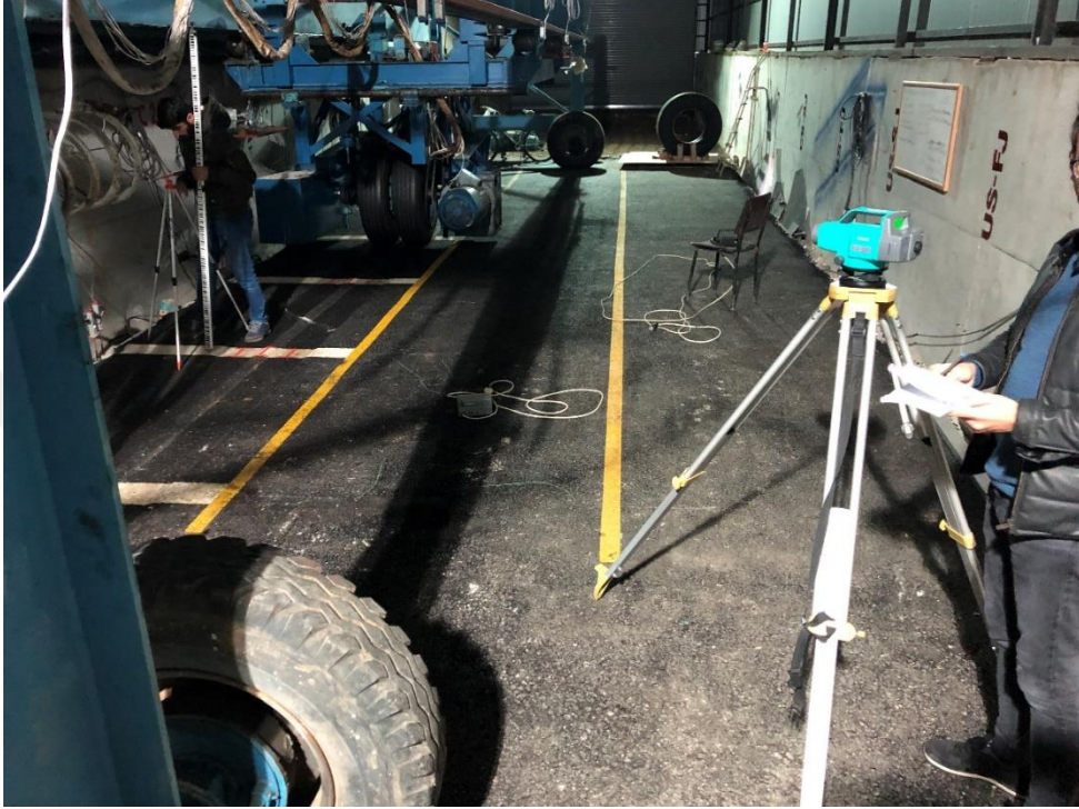
Şekil 2.70. Tekerlek izi oluşumlarının takibi için alınan hassas ölçümler
