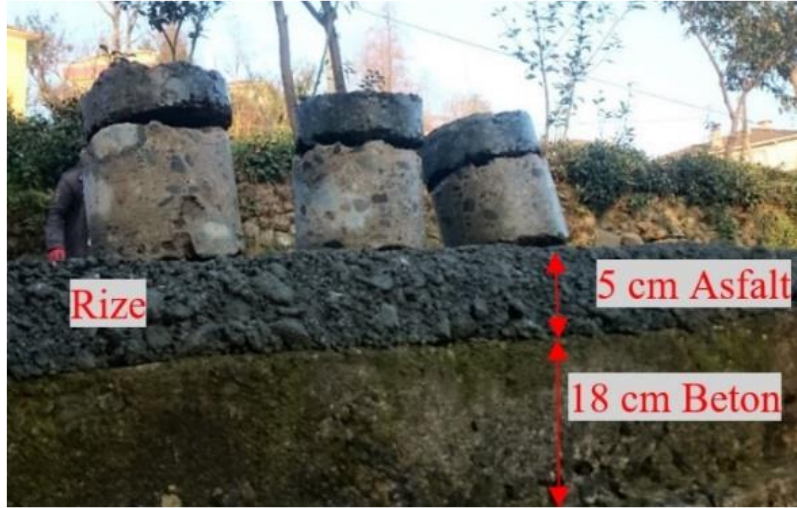
Şekil 1.19. Rize İlinden alınan BÜİAK numuneler
