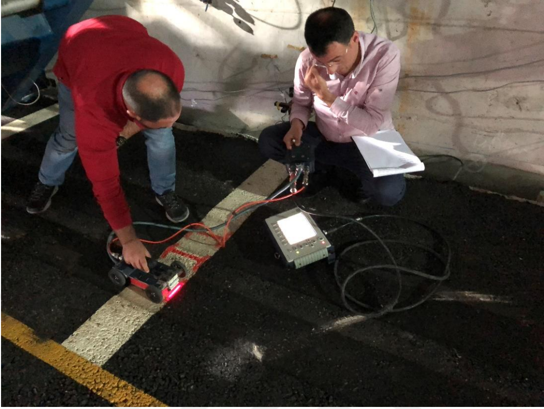
Şekil 2.75. Zimer Mühendislik'e ait UT cihazı ile asfalt kaplamada ölçüm alınması
