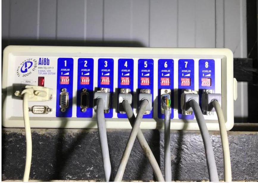
Şekil 2.28. LVDT'lerden elde edilen verilerin toplayıcısı
