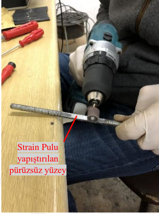
Şekil 2.39 Gerinim ölçer yapımı
