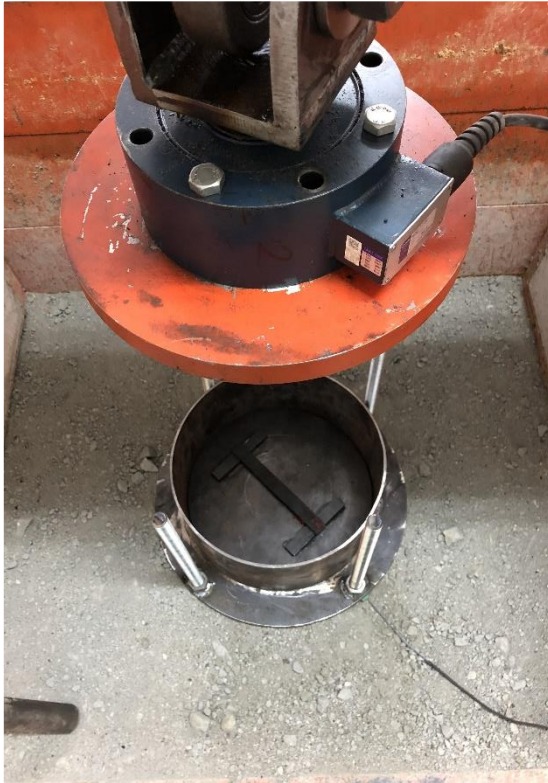
Şekil 2.41.Özel kalıp ve pullout düzeneği
