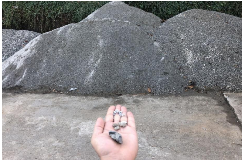
Şekil 2.12. Konkasörde kırılarak, KTÜ bünyesine geri getirilen malzeme
