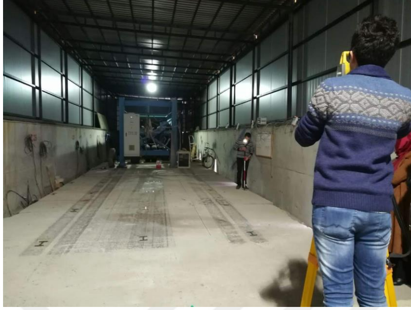
Şekil 2.52. Ölçüm aletlerinin yerlerinin hassas aletler ile tespiti
