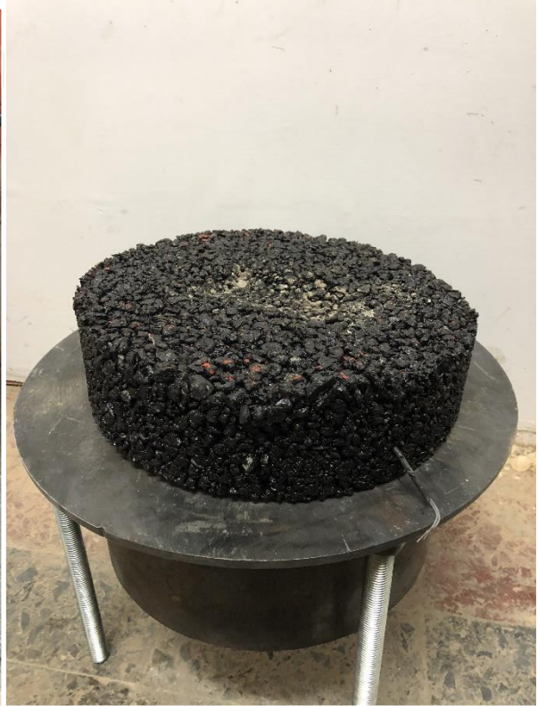
Şekil 2.42. Kalıpta gerinim ölçer denemesi
