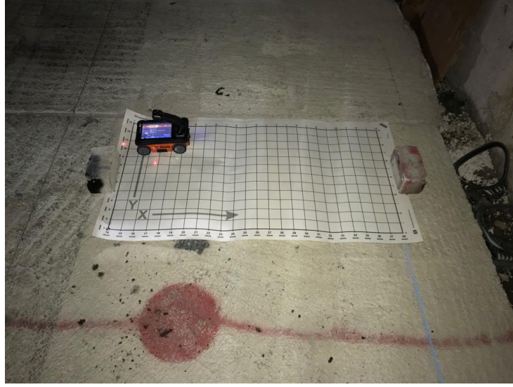
Şekil 2.15. Ultrasonik tomografi cihazı ile yükleme öncesi alınan ölçümler
