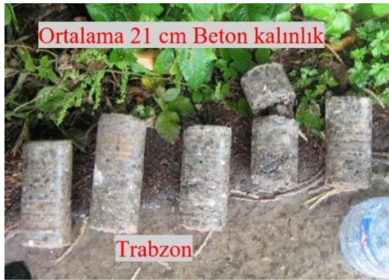
Şekil 1.18. Trabzon İlinden alınan beton numuneler
