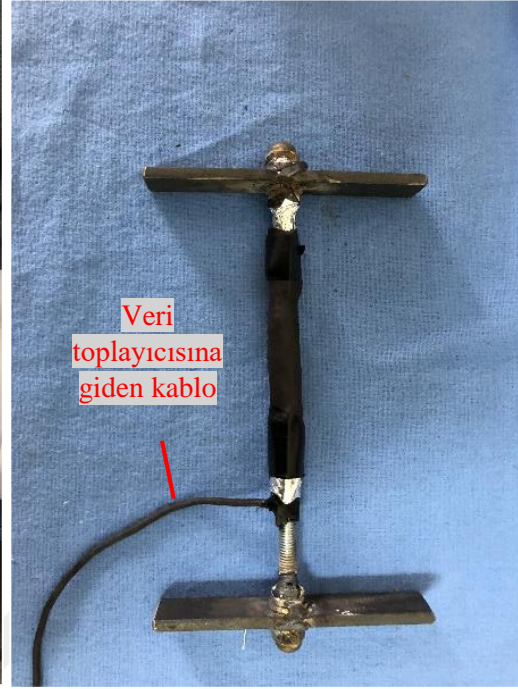
Şekil 2.40. Asfalt gerinim ölçer bitmiş hali
