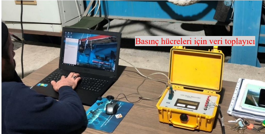
řekil 2.20. Deneylerde kullanılan basınç ölçer veri toplayıcısı
