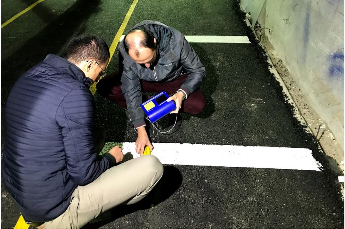
Şekil 2.64. Donatı bulma cihazı ile asfalt içinde ölçüm cihazlarının yerinin bulunması
