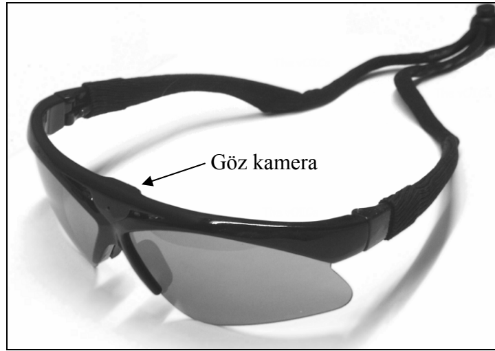
Şekil 1.12. Üzerinde gizli kamera bulunan gözlük modeli
