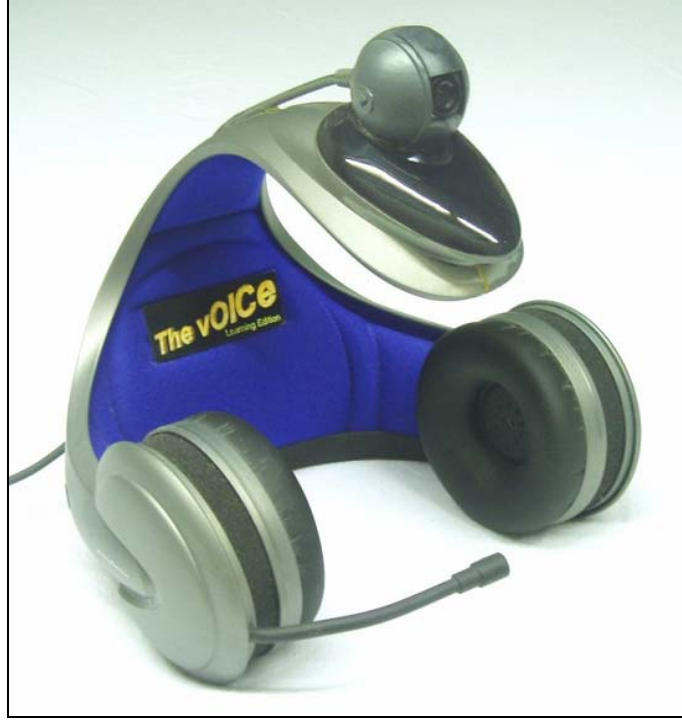
Şekil 1.11. Görme engelliler için geliştirilen kameralı başlık
