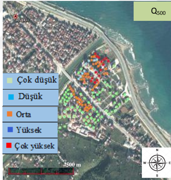
Ek Şekil 12. Araklı Karadere Deresi için Dinh yöntemine göre taşkın risk sınıflandırma
