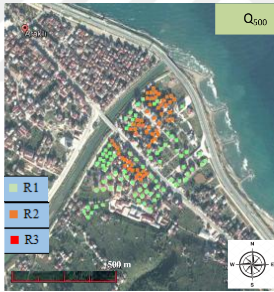
Ek Şekil 10. Araklı Karadere Deresi için Kılavuz yöntemine göre taşkın risk sınıflandırma
