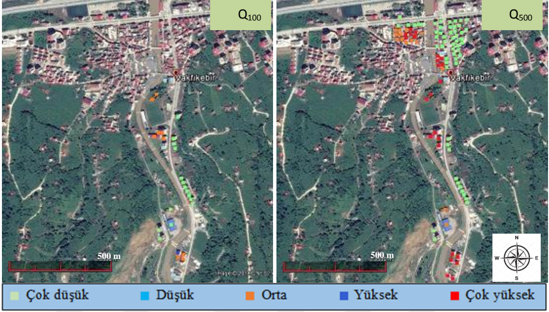
Ek Şekil 11. Vakfikebir Fol Deresi için Dinh yöntemine göre taşkın risk sınıflandırma
