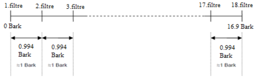
Şekil 2.5. Bark ölçekli bir filtre kümesindeki merkez frekansın dağılımı (Nyquist frekansı = 5 kHz (16.9 Bark))
